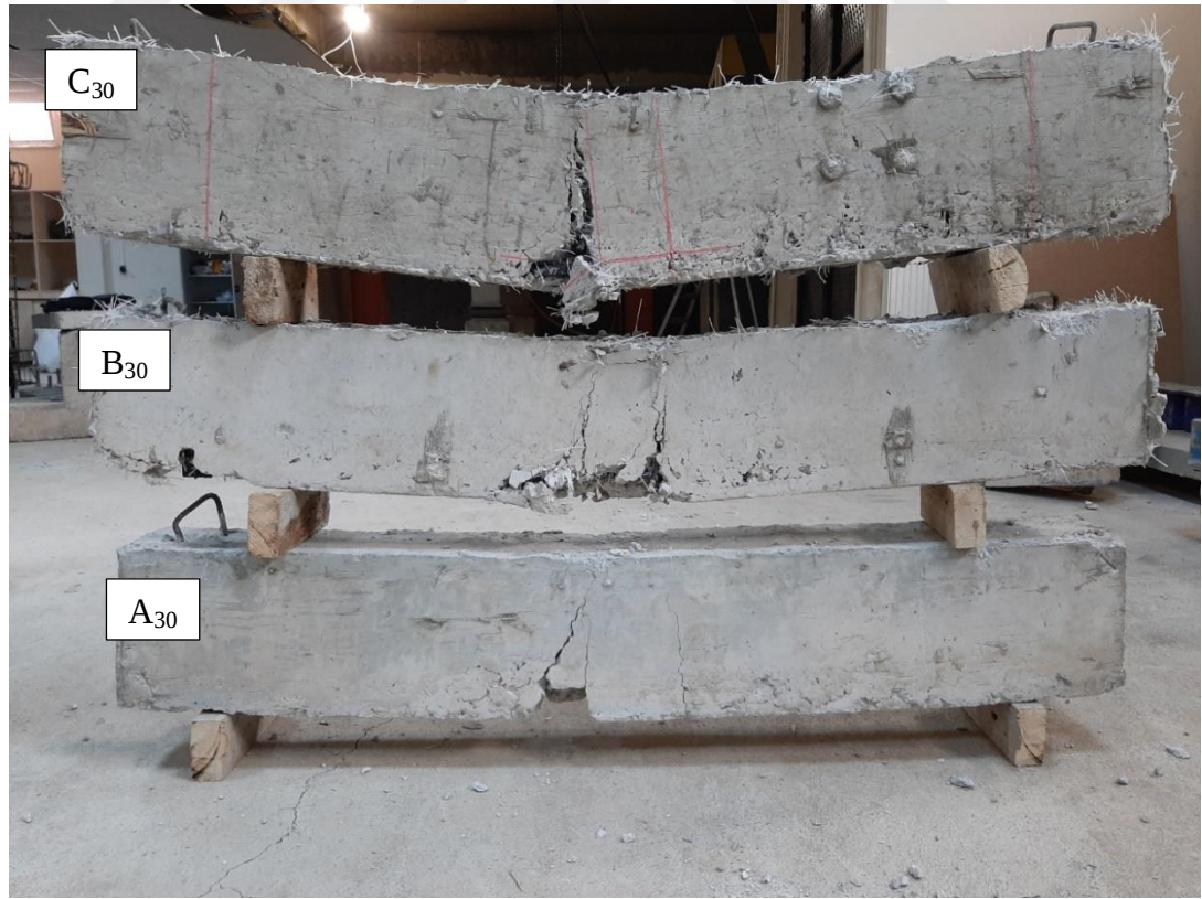
Şekil 4.4. l_d = 30 \text{ cm} bindirme boyuna sahip numunelerinin göçme modu
