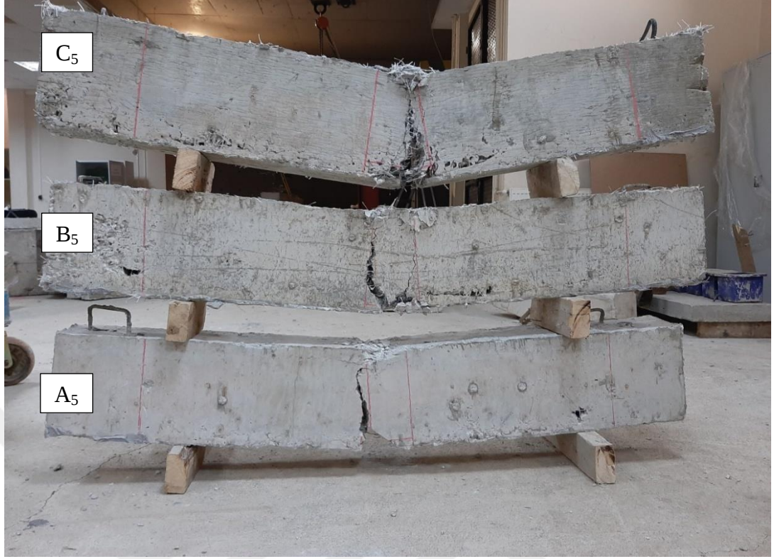
Şekil 4.6. l_d = 5 \text{ cm} bindirme boyuna sahip numunelerinin göçme modu
