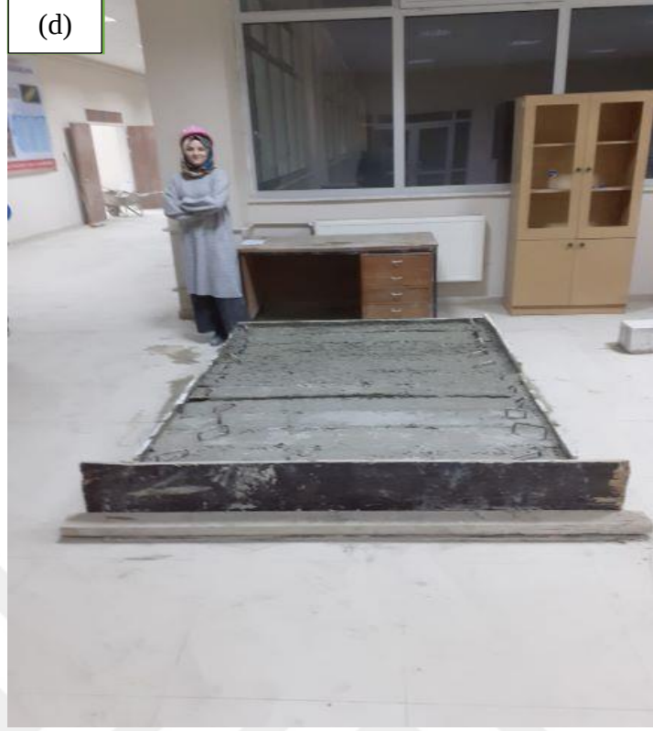
Şekil 3.7. (a), (b), (c), (d) Deneysel çalışma kapsamında üretilen betonarme kiriş numuneleri
