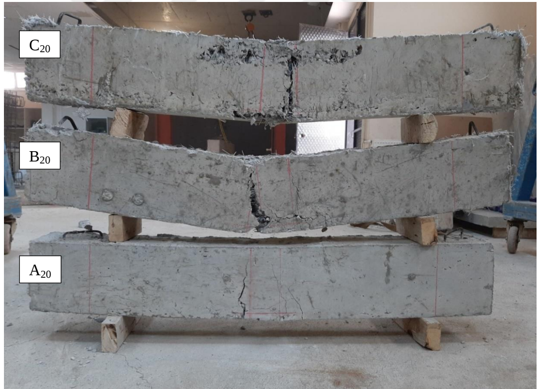
Şekil 4.5. l_d = 20 \text{ cm} bindirme boyuna sahip numunelerinin göçme modu
