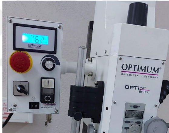
řekil 3.11. Dönme devrinin ayarlanması
