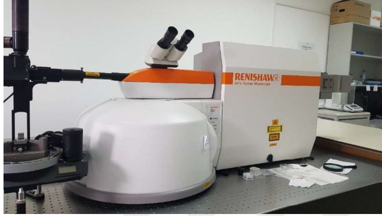
Görsel 7.4. Raman spektroskopisi cihazı
