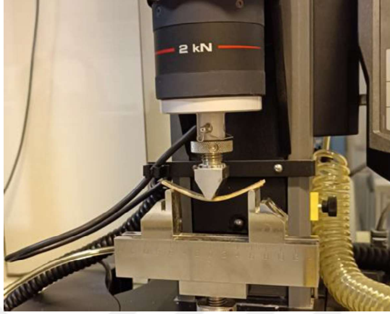
Görsel 7.15. (Devam) 3 nokta eğme testi
