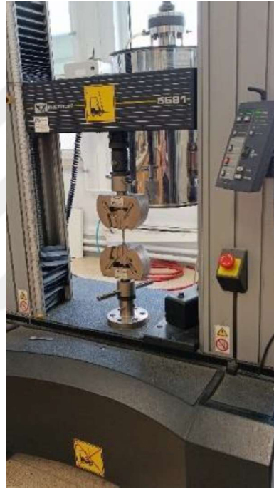
Görsel 7.12. Çekme testi numuneleri ve çekme testi cihazı
