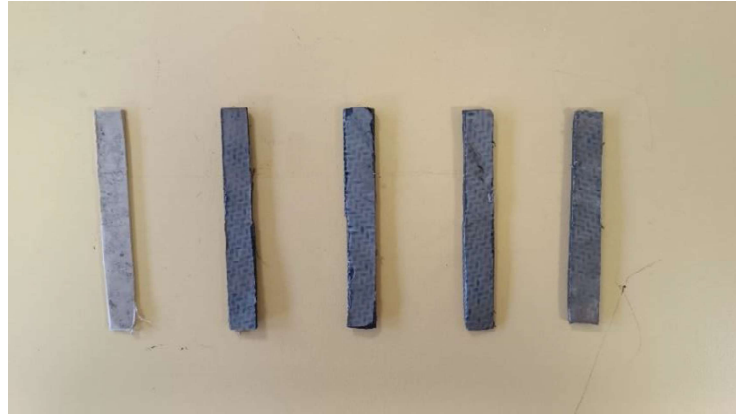
Görsel 7.15. 3 nokta eğme testi
