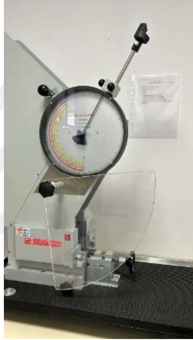
Görsel 7.13. Darbe dayanımı numuneleri ve cihazı
