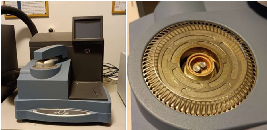
Görsel 7.18. DSC cihazı ve numunelerin hücreye yerleştirilmesi
