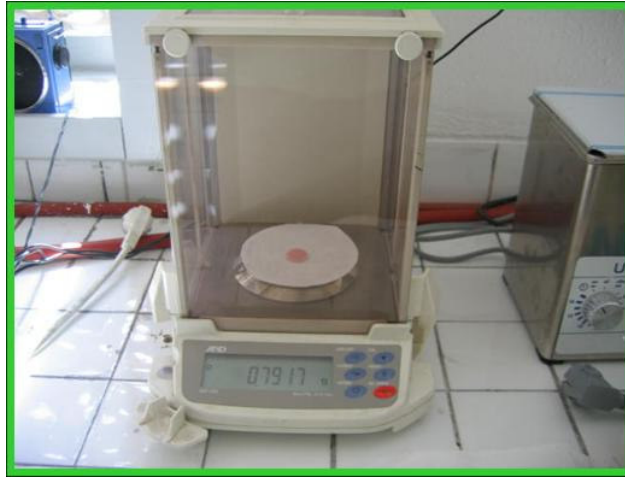
Resim 7: Hassas terazi ve örneğin tartılması
