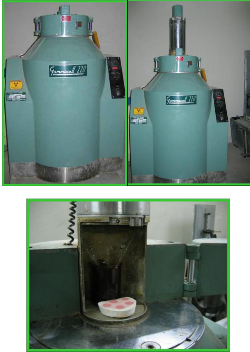
Resim 5: Gama cell 220 cihazı ve akrilik örneklerin cihaz içerisindeki görünümü
