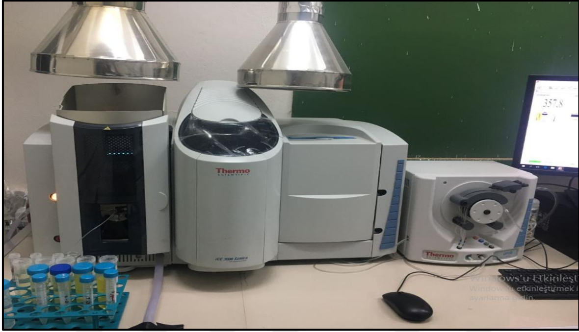
Şekil 3.1: Element iyonlarının ölçümleri için kullanılan (FAAS)
