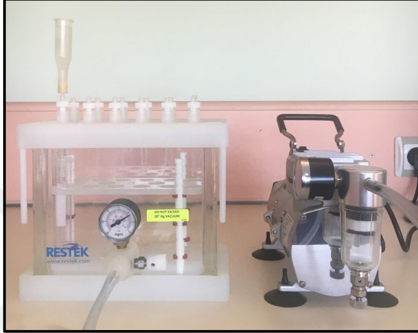
Şekil 4.18: SPE için kullanılan manifold
