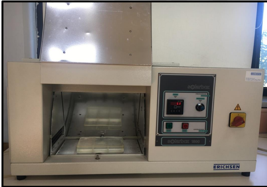
Şekil 3.3: Organik kirliliklerin fotokatalitik yıkımı için kullanılan fotoreaktör
