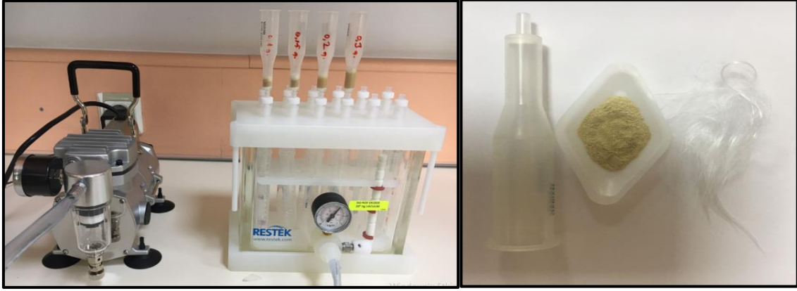
Şekil 3.2: Kolon çalışmalarında kullanılan SPE sistemi ve kolonun kısımları
