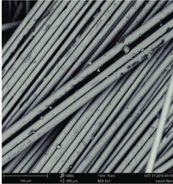
Şekil 3.2. Bazalt fiber SEM görüntüsü
