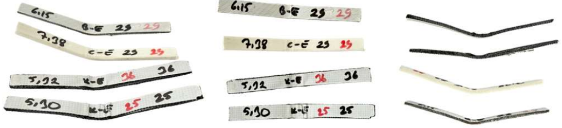
Şekil 4.16. Üç nokta eğilme testi sonrası numune görüntüsü
