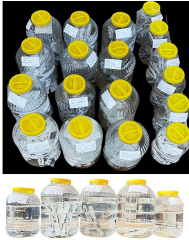
Şekil 3.15. Tuzlu su ortamında bekletilen numuneler
