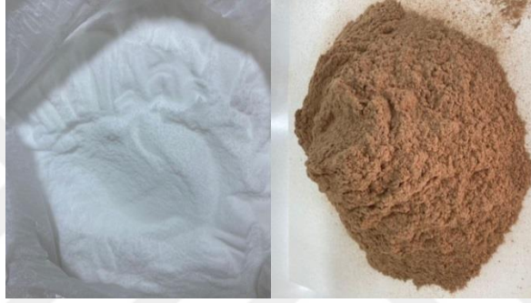
Şekil 3.1. HDPE (sol) ve MDF (sağ) numuneleri
