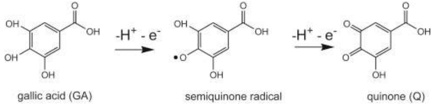
Şekil 2.11. Gallik asitin yükseltgenme reaksiyonu.
