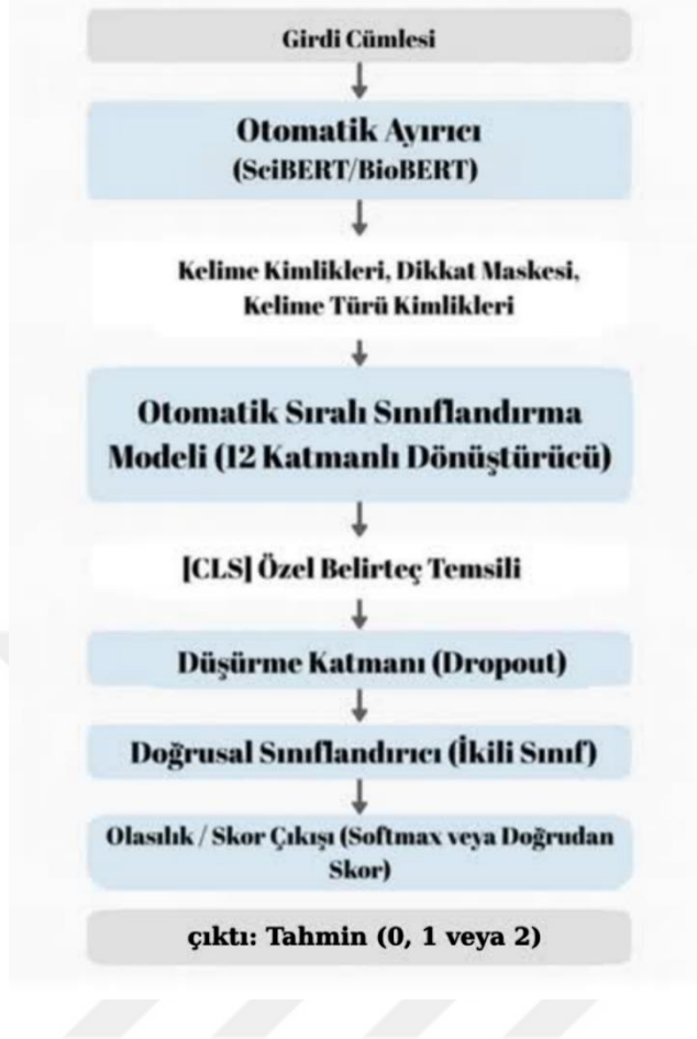
Şekil 3.4. SciBERT/BioBERT tabanlı metin sınıflandırma modelinin mimarisi
