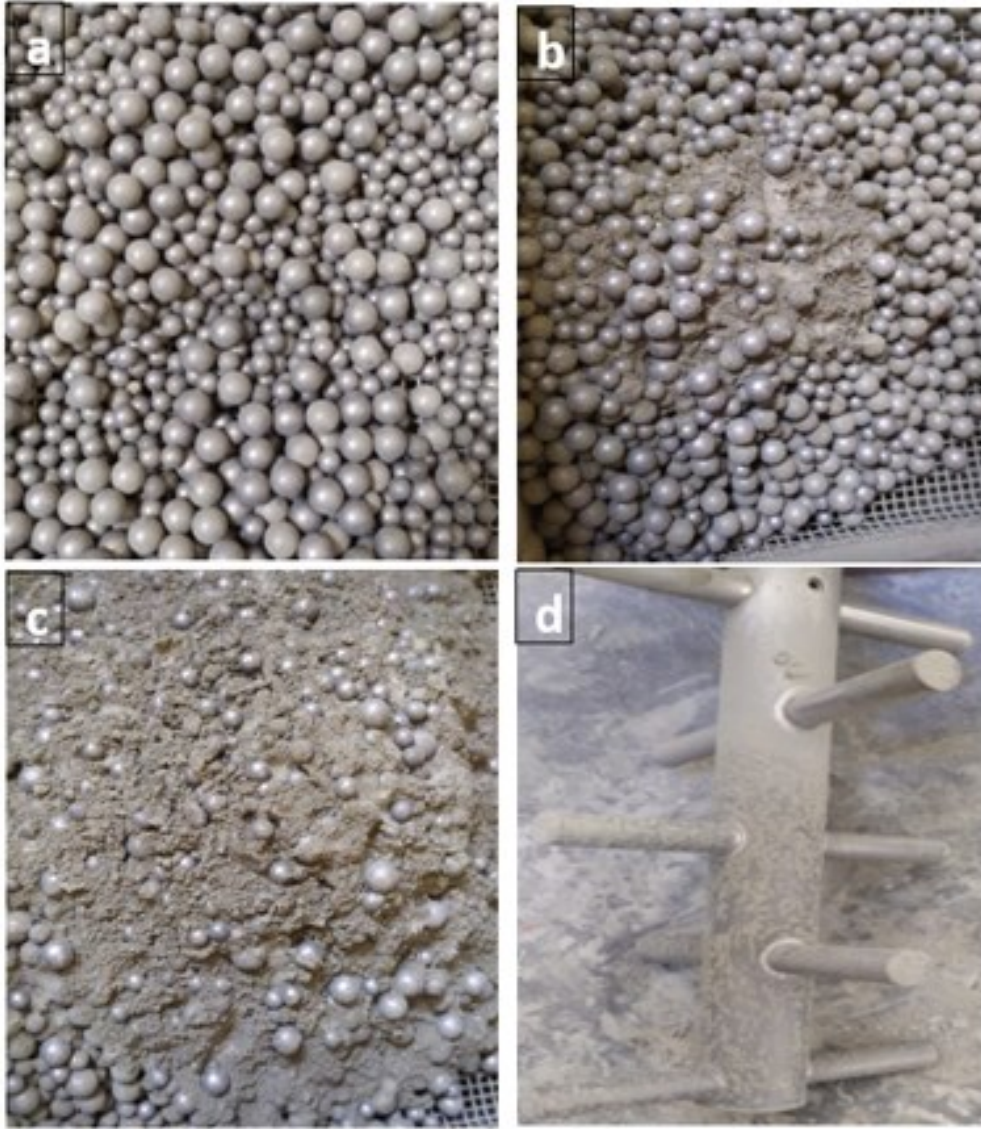
Resim 4.12. a) Temizlenmiş bilyeler (öğütme öncesi) b ve c) PCE-AgNPs katkılı öğütme sonrası, d) Öğütme sonrası karıştırma mili
