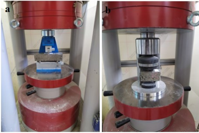
Resim 4.23. a) Eğilme dayanımı testi b) Basınç dayanımı testi
