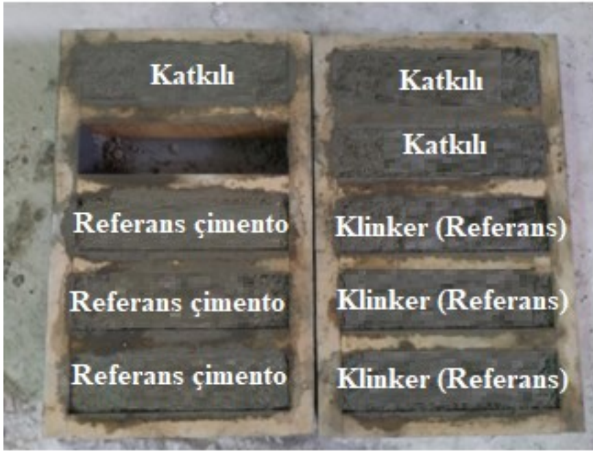
Resim 4.21. Harçların kalıplara yerleştirilmesi
