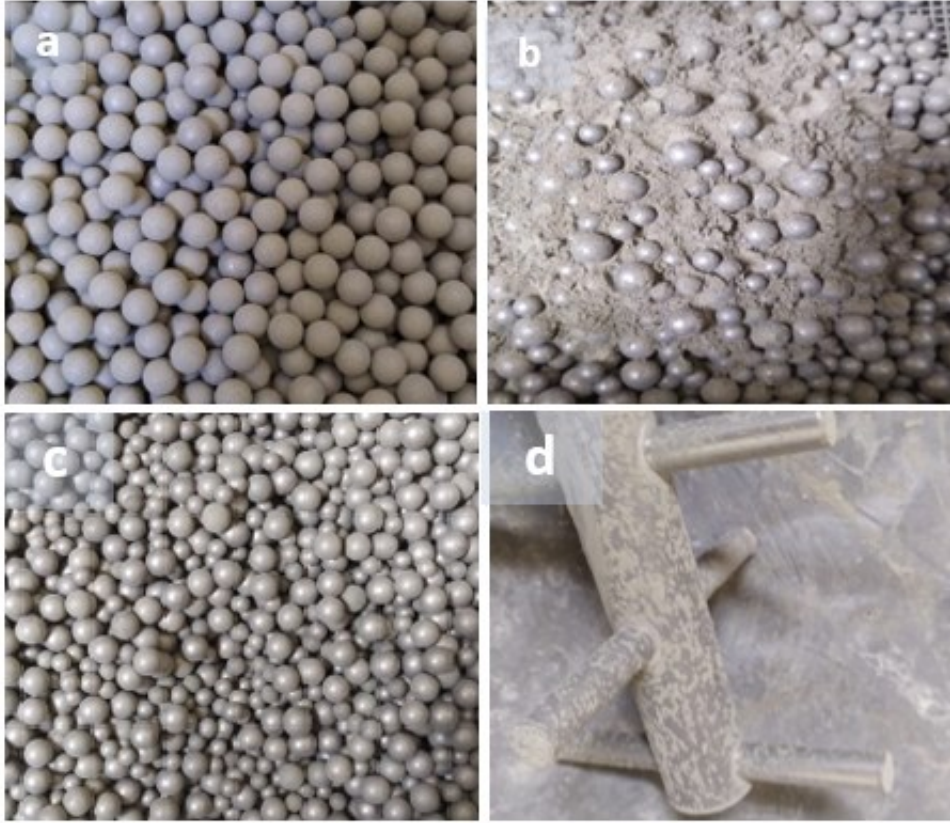
Resim 4.10. a) Klinker öğütmesinden sonra bilyeler, b) PCE li klinker öğütme sonrası, c) PCE li klinker öğütmesinden sonra bilyeler, d) PCE li klinker öğütmesinden sonra karıştırma mili
