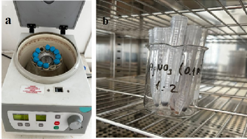
Resim 3.9. a) PCE-AgNPs'in santrifüjlenmesi b) PCE-AgNPs'in kurutulması
