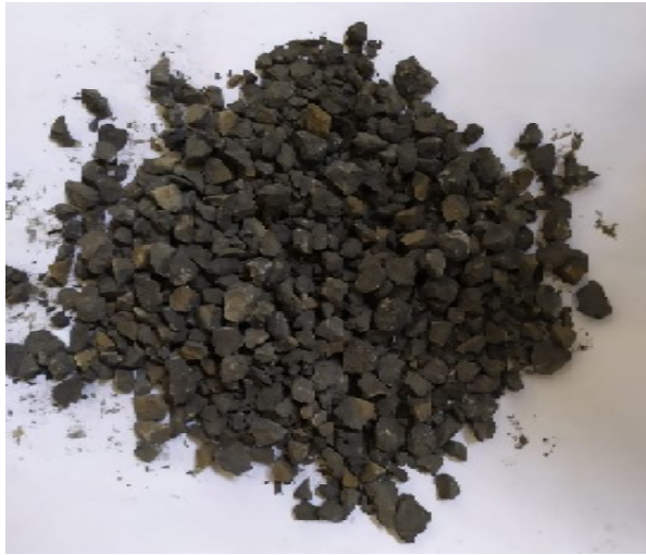
Resim 4.1. Klinkerin el ile kırılıp tanecik boyutunun küçültülmesi
