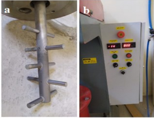
Resim 3.3. a) Cihaz karıştırma mili b) Cihaz paneli
