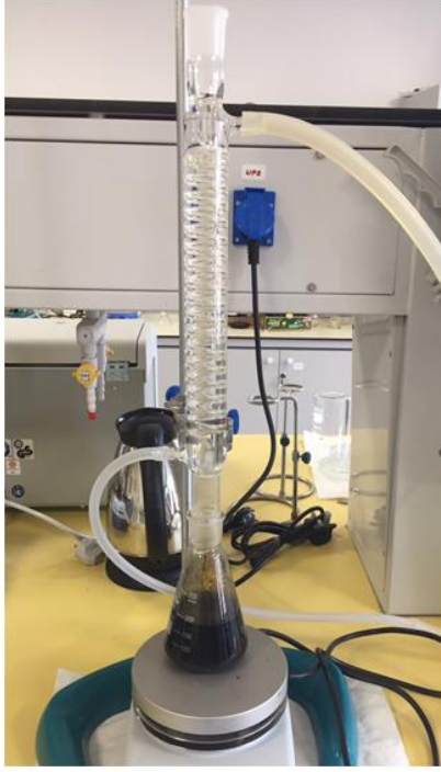
Şekil 7.3. \text{HNO}_3 modifikasyonu deney düzeneği
