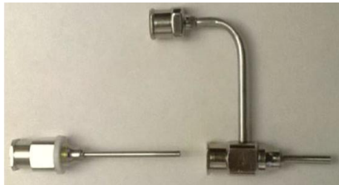
Şekil 3.4. Ortak eksenli iğne [105]
