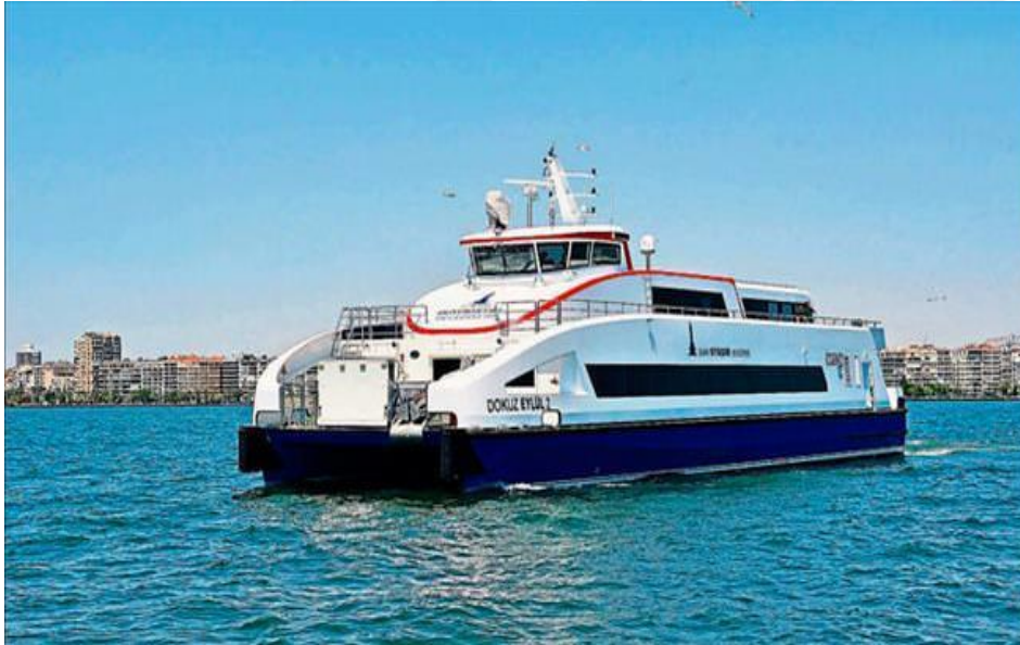
Şekil 3.4. Kompozit malzemeden üretilen bir yolcu feribotu (Haberler.com, 2014)
