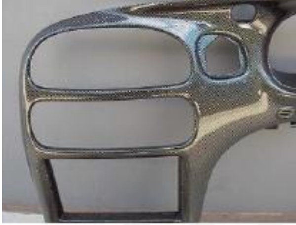
Şekil 3.5. Kompozit malzemeden üretilen otomobil ön paneli (Akpınar, 2016).
