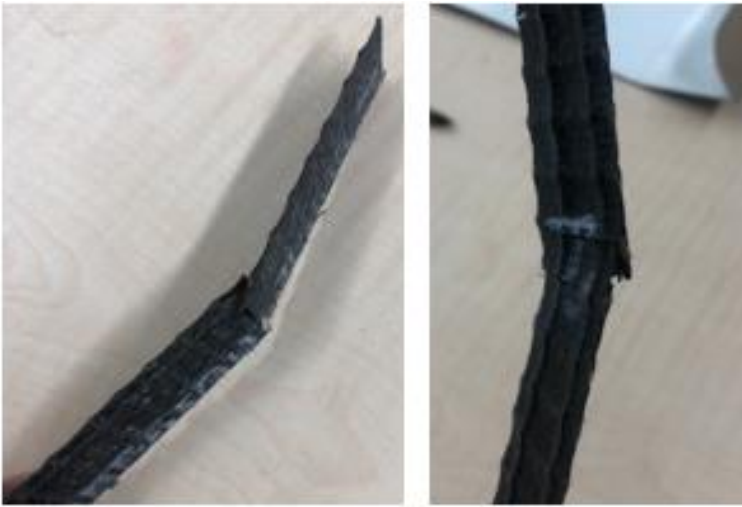
Resim 5.2. Eğilme deneyi sonrasına örnekler
