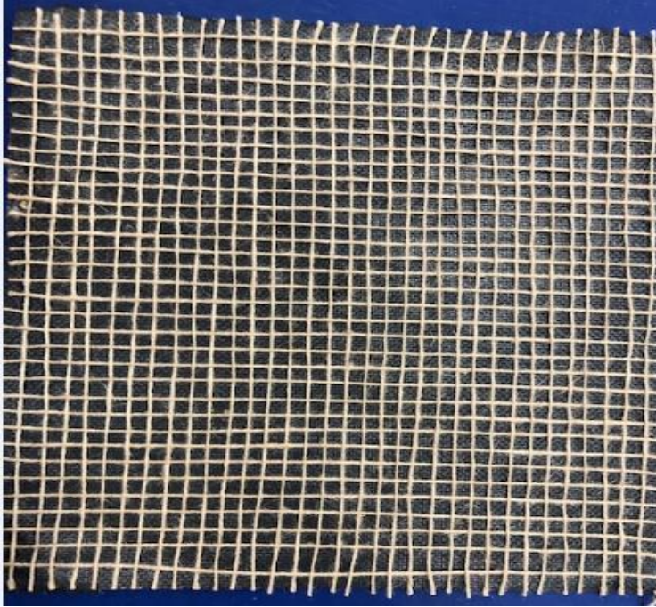
Resim 4.5. Keten örgü yerleştirilmiş prepreg
