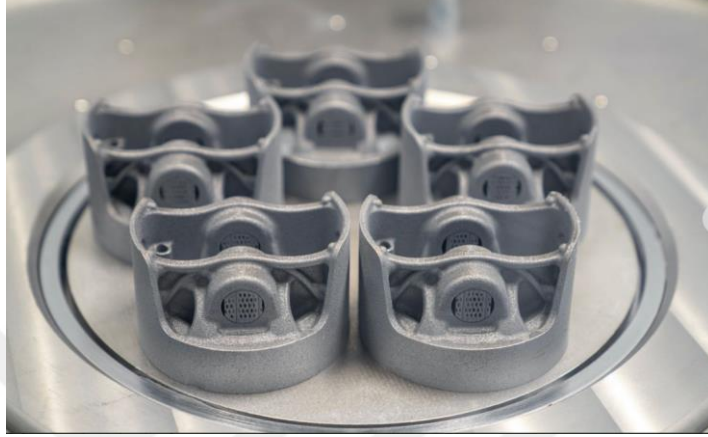
Şekil 2.31 : Porsche’nin üç boyutlu yazıcı ile ürettiği piston örnekleri [70].
