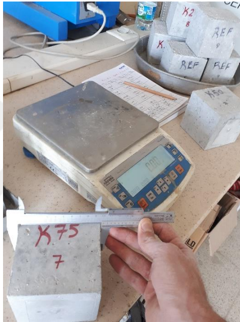
Şekil 2.9. Beton numunelerinin tartılması ve boyutlarının ölçülmesi
