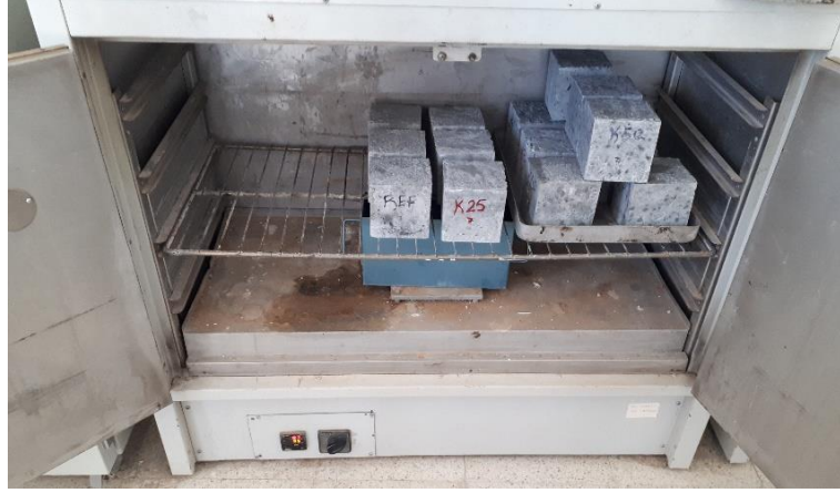
Şekil 2.8. Beton numunelerinin etüvde kurutulması
