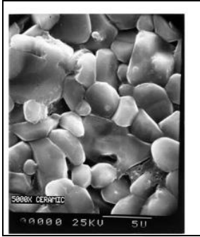
Şekil 3.23. % 96 ergimiş döküm alümina yüzeyinin SEM resmi [24]
