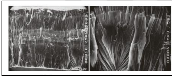
Şekil 3.22. Vakumla biriktirilmiş berilyumda sütunlu morfolojiyi gösteren frakrograf [24]
