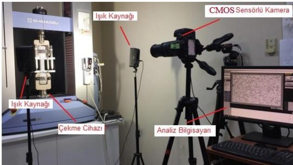
Şekil 3.10 Dijital görüntü korelasyonu ve tek eksenli çekme deneyi düzeneği (Kişisel arşiv, 2020)
