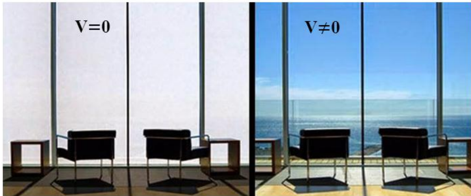
Şekil 3.8. PDSK filmlerin akıllı pencerelerde kullanımı.
