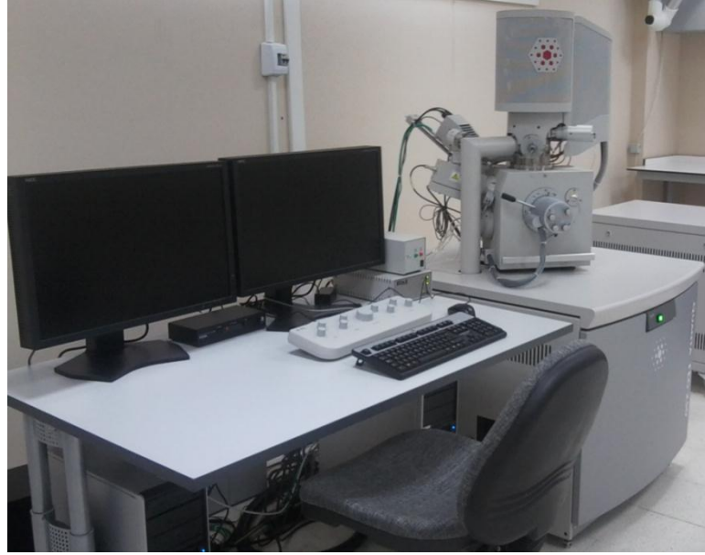
Şekil 5.11. Morfolojik ölçüm için kullanılan SEM cihazı.
