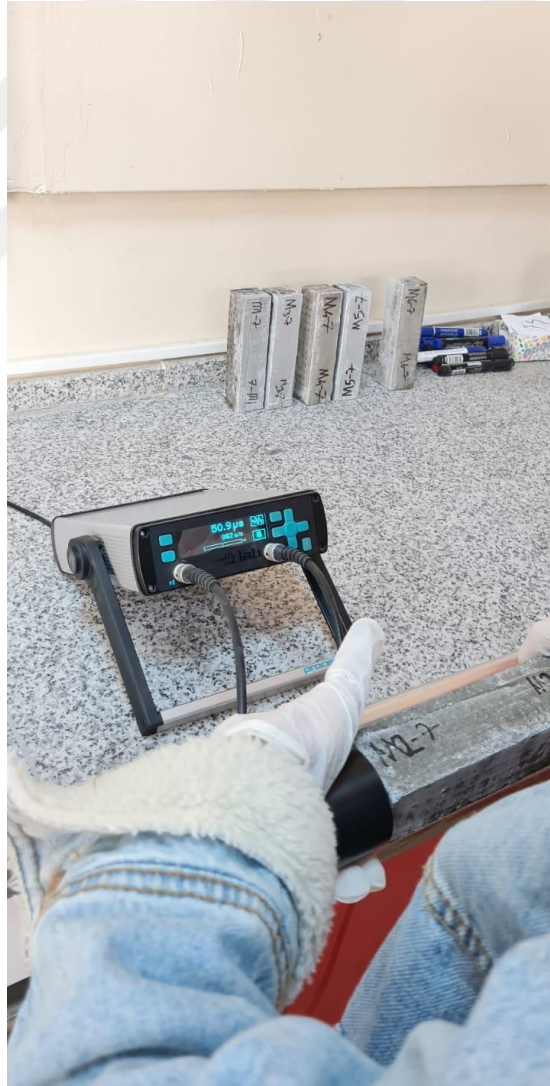
Şekil 3.17. UPV Testi Düzenegİ
