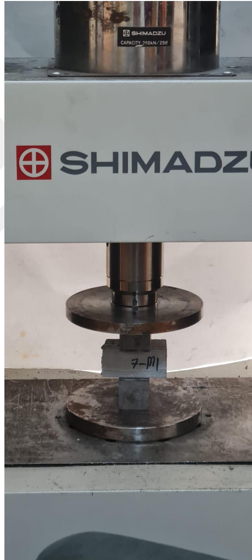
Şekil 3.16. Basınç Testi Düzeneği
