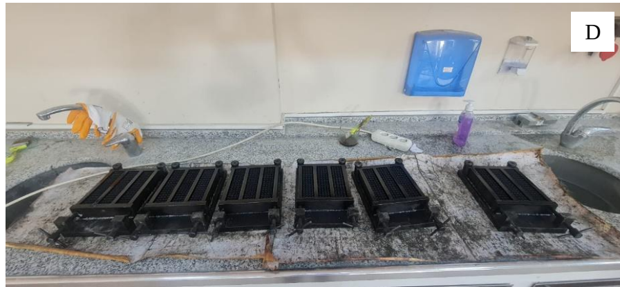
Şekil 3.9. Kalıp Hazırlığı ve Kafes Yerleşimi
