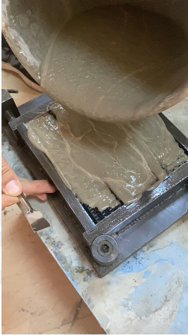
Şekil 3.12. Harcın kalıba dökülmesi
