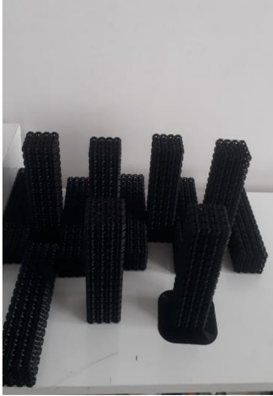
Şekil 3.8. 3D Yazıcı ile Üretilmiş Rombiküboktahedron Hücreli PETG Kafes Görüntüsü
