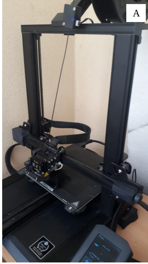
Şekil 3.7. 3D Yazıcıda Kafes Elemanın Üretim Süreci
