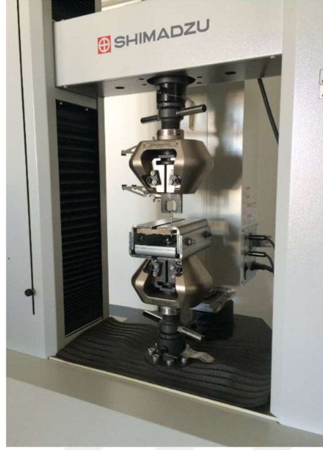
Şekil 5.20: Çivi çekme aparatlarının çekme cihazında kullanımı.
