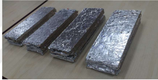
Şekil 5.15: 3 nokta eğme deneyi numuneleri.
