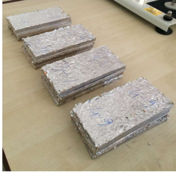
Şekil 5.18: Çivi çekme deneyi numuneleri.
