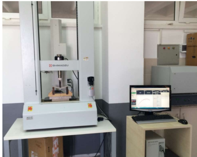
Şekil 5.16: 3 nokta eğme deneyinin çekme cihazında yapılışı.
