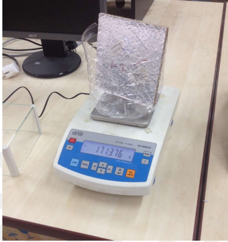
Şekil 5.22: Numunelerin ağırlık ölçümü.
