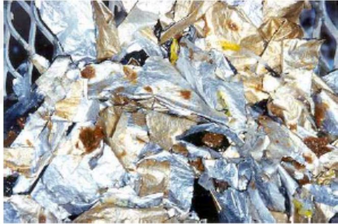
Şekil 2.6: Döner tambur aşamasından sonra polietilen ve alüminyum.
