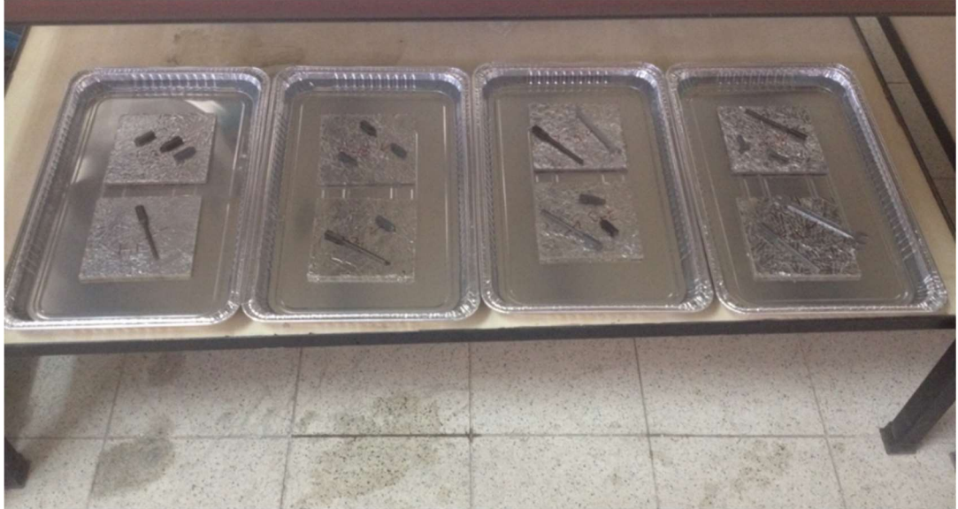
Şekil 5.21: Numunelerin saf suda bekletilmesi.
