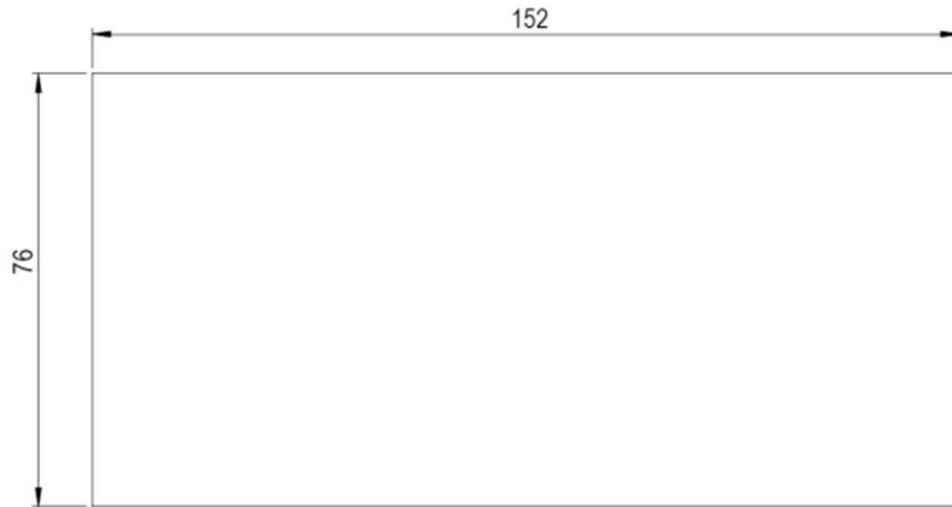
Şekil 5.10: Çivi çekme deneyi numunesi ebatları.
