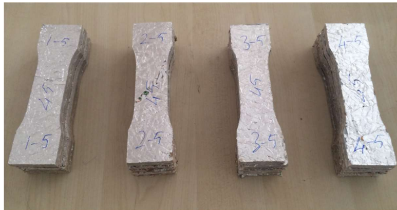
Şekil 5.12: CNC tezgahta işlenerek oluşturulan çekme numuneleri.
