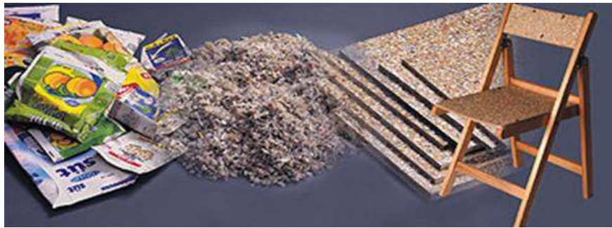
Şekil 2.1: Yonga levha üretim aşamaları.
