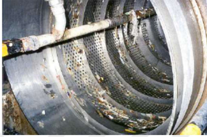
Şekil 2.5: Polietilen ve alüminyumun temizlenmesinde döner tambur.
