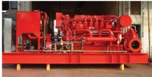
Yangın su pompası
