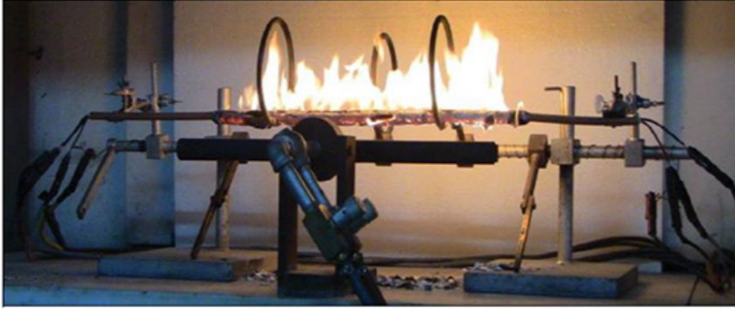
Şekil 2.5. IEC 60331 test düzeneği [20]
