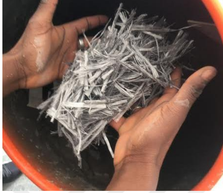
Fotoğraf 2. Deneyde Kullanılan Polipropilen Lifler
