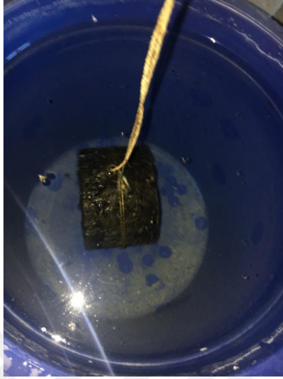
Şekil 3.12. Marshall numunelerinin sudaki ağırlığının tartılması
