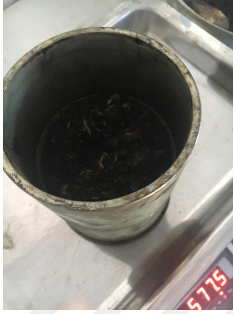
Şekil 3.6. Marshall deney çalışmasında karışımın kalıplara konulması
