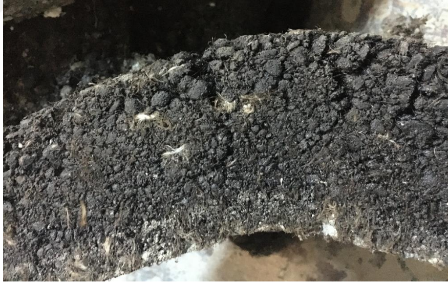
Şekil 3.32. Kiriş eğilme deneyinde sehim yapmış numune
