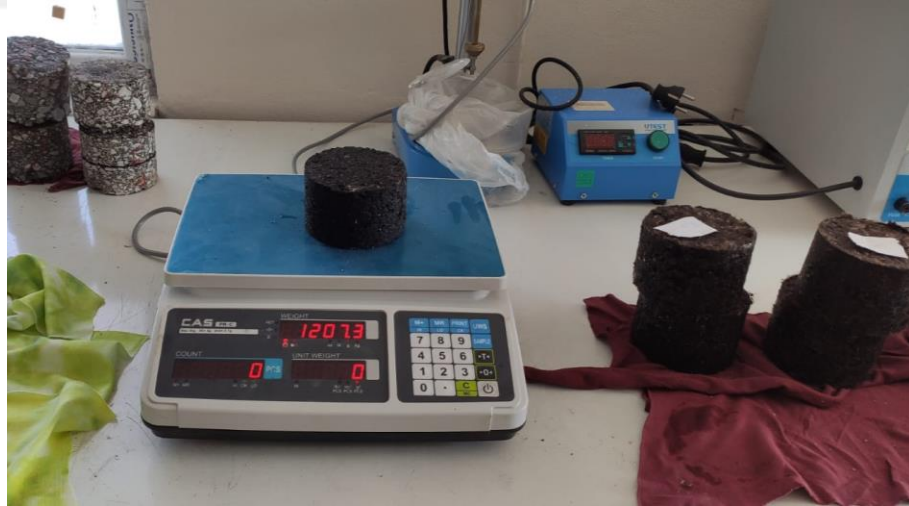
Şekil 3.11. Marshall numunelerinin havadaki ağırlığının tartılması
