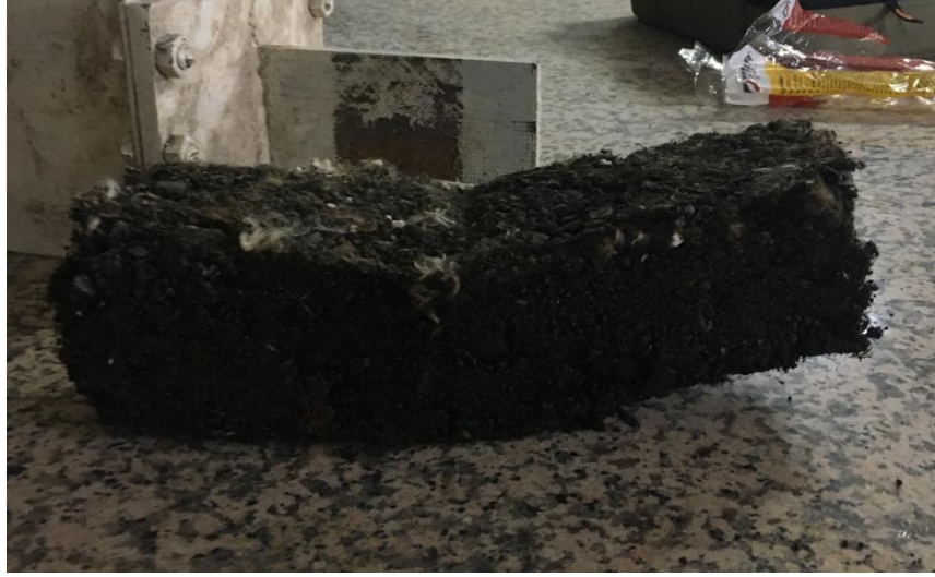
Şekil 3.29. Sehim yapmış numune düz zemine bırakılmış hali
