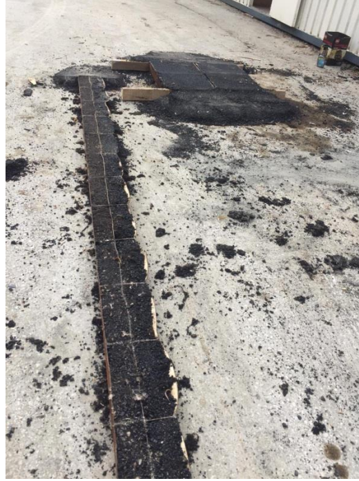
Şekil 3.18. Kiriş eğilme deney numunelerinin kalıp içinde sıkıştırma işlemi
