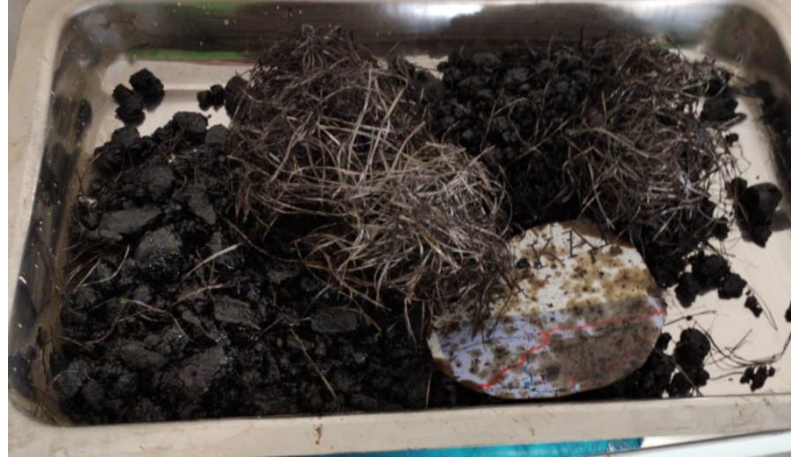
Şekil 3.4. 54mm PP lif katkılı Marshall deney çalışması
