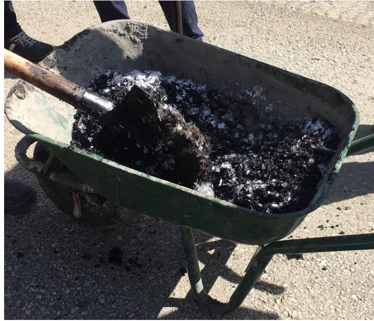
Şekil 3.20. Kiriş eğilme deney numuneleri için BSK'a PP lif karıştırma işlemi 2
