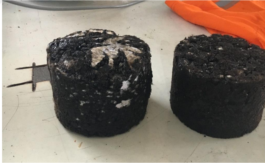
Şekil 3.15. Marshall numunesinin kırılmadan sonraki görüntüsü
