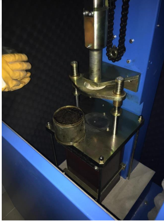
Şekil 3.7. Marshall numunelerinin sıkıştırma işlemi
