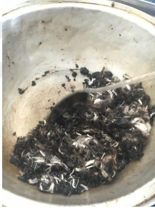
Şekil 3.5. Marshall deney çalışmasında BSK'a PP lif karıştırılması
