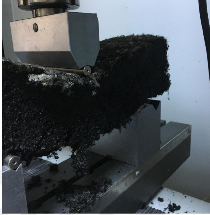
Şekil 3.31. Kiriş eğilme deney çalışması sırasında dağılan numune
