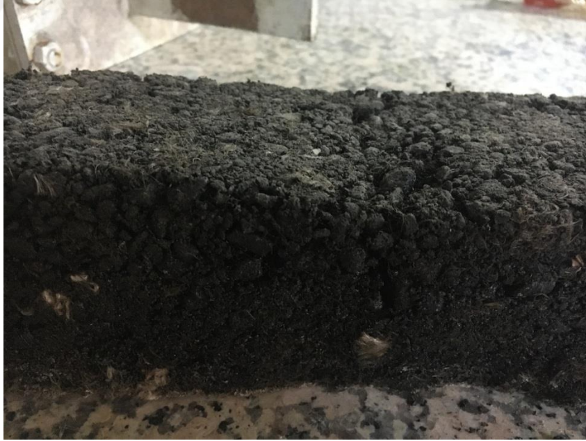
Şekil 3.28. Kiriş eğilme deney sonrası numunenin görseli
