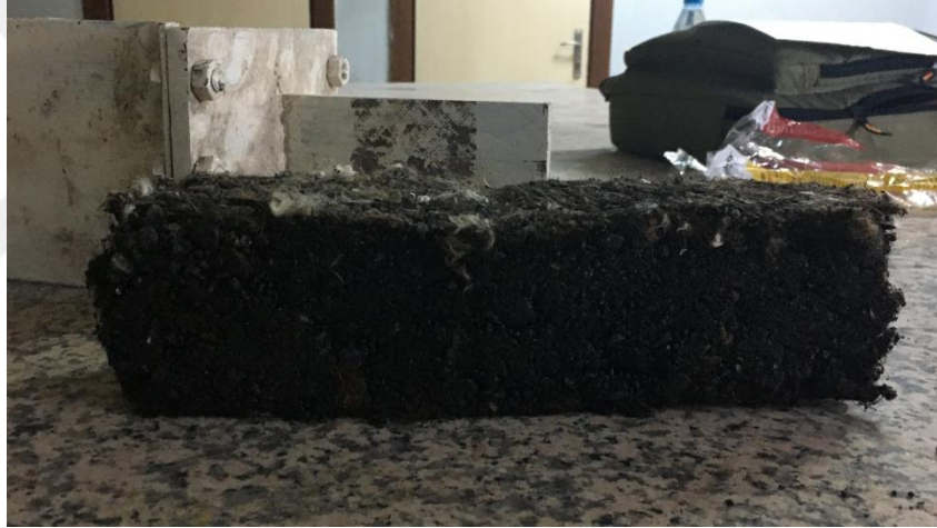
Şekil 3.30. Sehim yapmış numune düz zemine bırakıldıktan 1-2 dk sonraki hali
