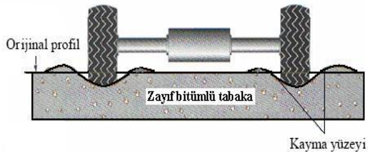
Şekil 2.8. Zayıf bitümlü tabakada tekerlek izi oluşumu [1]
