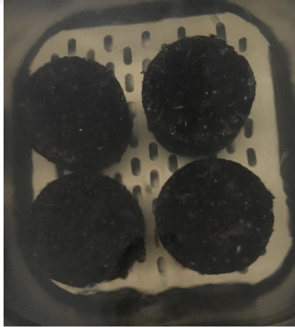
Şekil 3.13. Marshall numunelerinin sıcak su banyosunda bekletilmesi
