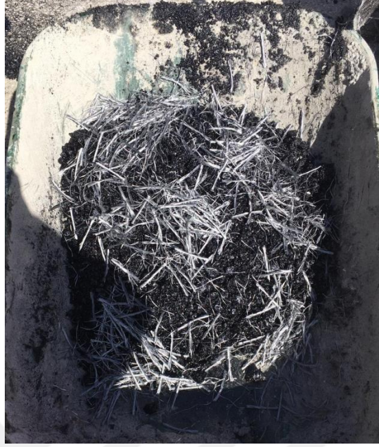
Şekil 3.19. Kiriş eğilme deney numuneleri için BSK'a PP lif karıştırma işlemi 1
