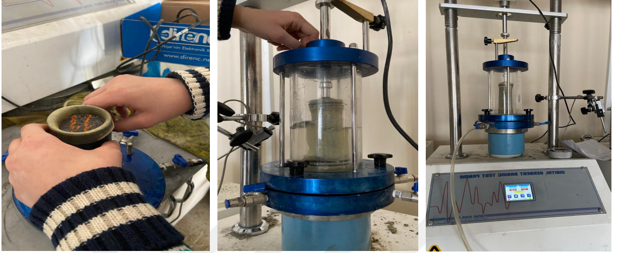
Şekil 15. Üç eksenli basınç deneyi uygulama aşamaları
