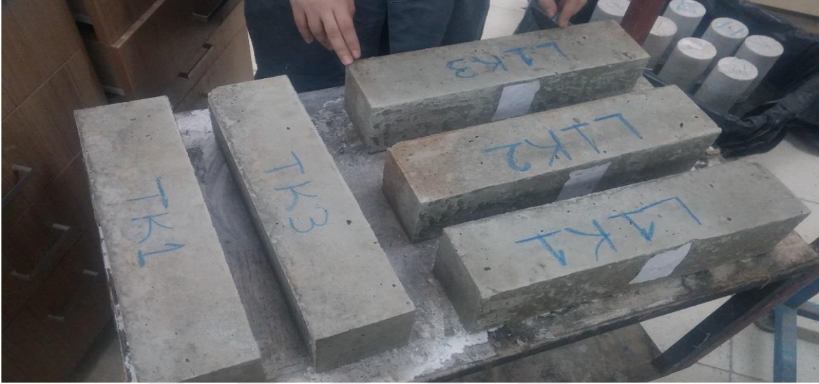
Şekil 2.14. Denede üretilen kiriş beton numuneleri
