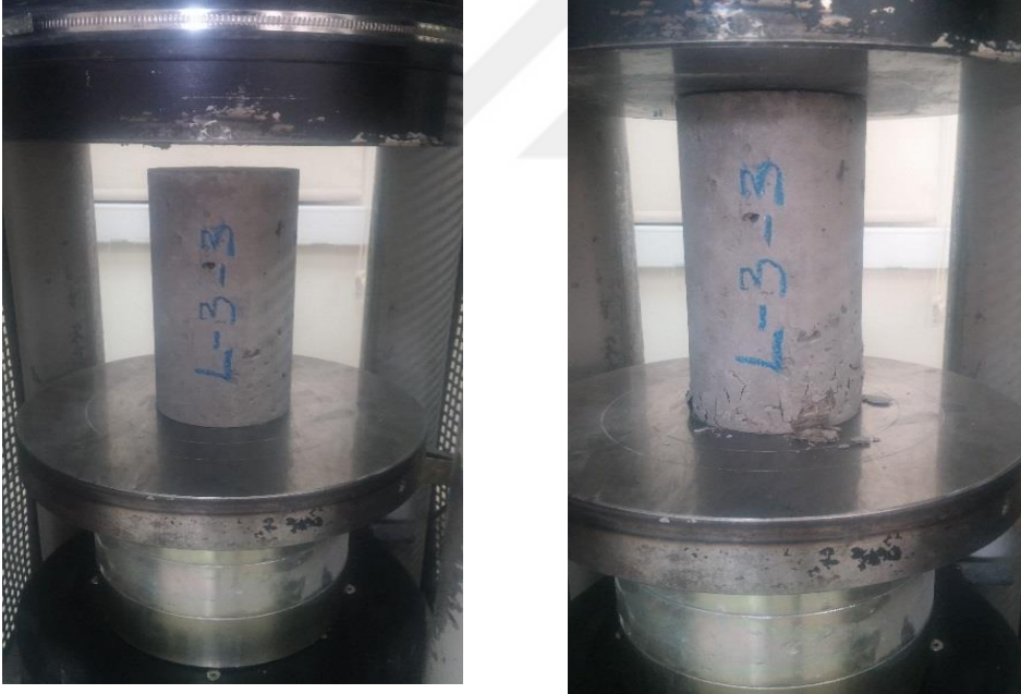
Şekil 2.15. Uygulanan yük altındaki silindir numune
