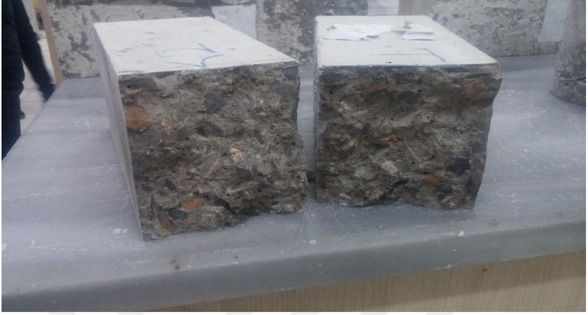
Şekil 2.18. Kırılan beton kiriş numunesi
