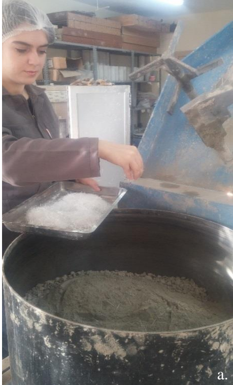
Şekil 2.11. a. Polipropilen lifli beton üretimi, b. numunelerin küre konulması
