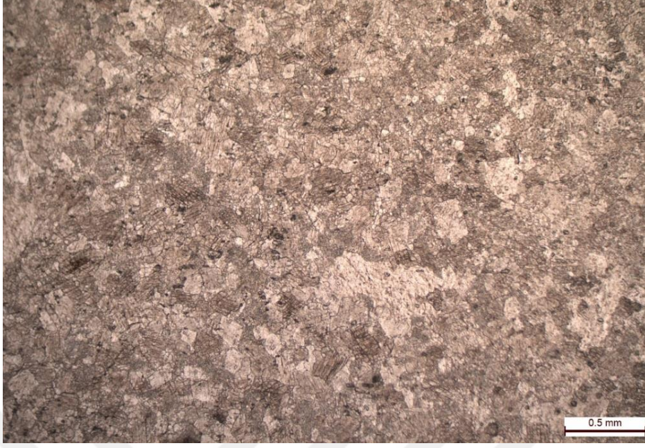
Şekil 2.6. Kristalize kireçtaşı örneğın mikroskobık görünümü (Görüntü tek nikolde alınmıştır.)
