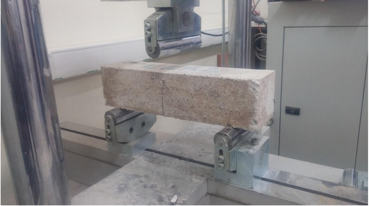
Şekil 2.17. Uygulanan yük altında kiriş numunede meydana gelen çatlama
