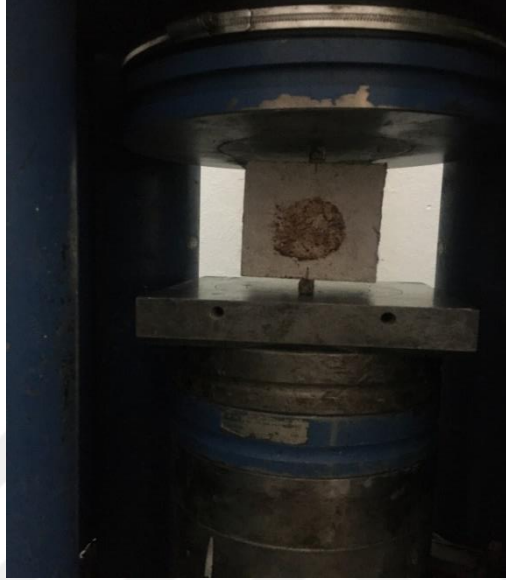
Şekil 3.6. Yarmada çekme cihazı
