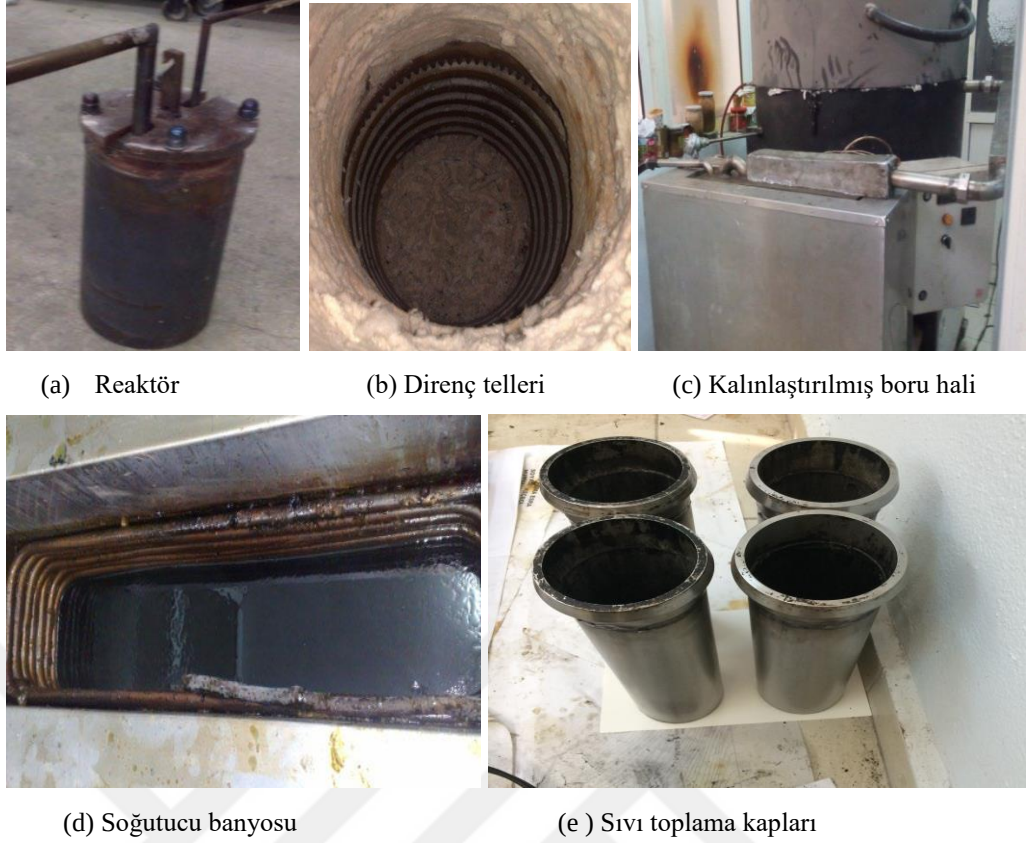
Şekil 3.13 Piroliz deney sistemin ekipmanları.
