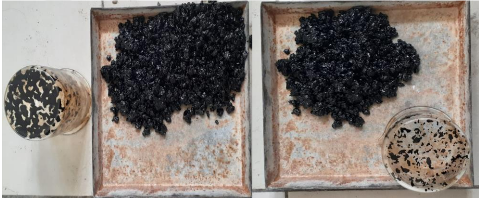
Şekil 3.17 Bitüm süzülme deneyi
