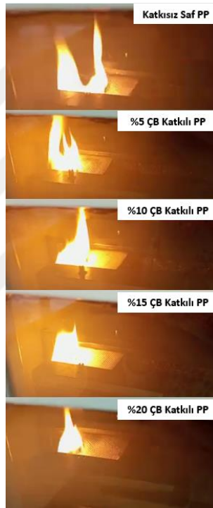
Şekil 3.19: Numunelerin 30.saniyedeki yanma hızlarındaki değişim.
