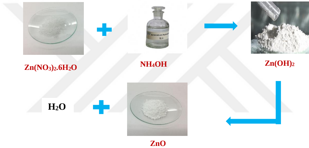
Şekil 3.4. \text{Zn}(\text{NO}_3)_2 \cdot 6\text{H}_2\text{O} 'dan nano-ZnO eldesine ilişkin şematik gösterim
