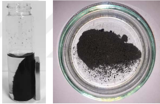
Şekil 4.2. Sentezlenen manyetik nanopartiküller saf su içerisinde (solda), kurutulup kazındıktan sonra (sağda)
