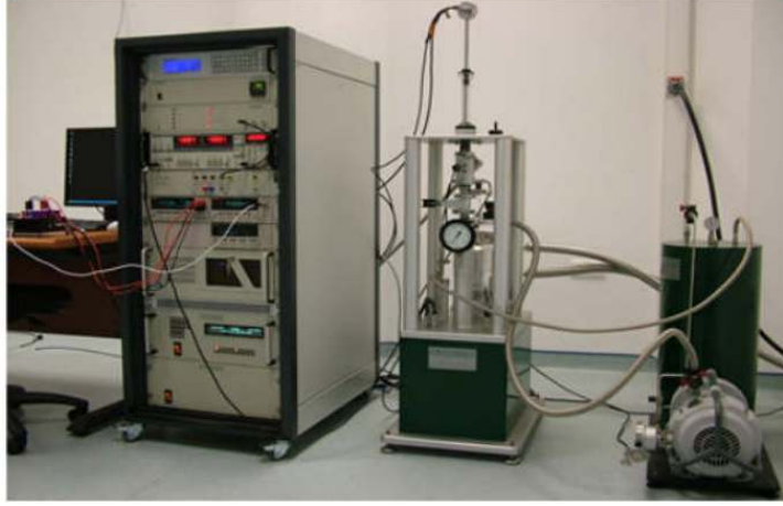
Şekil 4.10. VSM analizleri için kullanılan Cryogenic Limited PPMS (Elektrik, Manyetik ve Optik Özellikler Ölçüm Laboratuvarı (EMOL), 2021)
