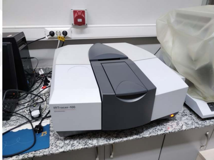
Şekil 4.7. FTIR analizleri için kullanılan Shimadzu, IR-Tracer 100 cihazı
