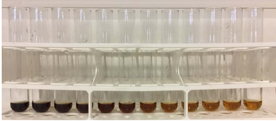
Şekil 4.14. Alfa amilaz aktivitesinin belirlenmesinde kullanılan nişasta-iyodin yönteminde, zamanla nişasta konsantrasyon düşüşünün gözlemlenmesi
