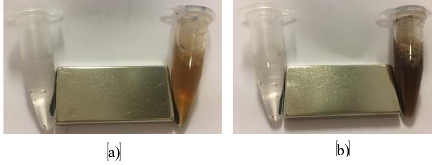
Şekil 5.15. Sonikasyon işlemi uygulanmayan (soldaki) ve uygulanan (sağdaki eppendorflar) a) çıplak ve b) %0,5 w/v agar solüsyonunda kaplanan partiküller
