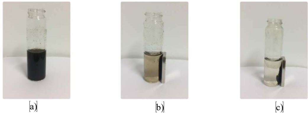
Şekil 4.5. Sentezlenen %0,5 w/v pektin kaplı manyetik nanopartiküllerin uygulanan manyetik kuvvet karşısında gösterdikleri manyetik özellik (a) 0 s, (b) 30 s, (c) 165 s
