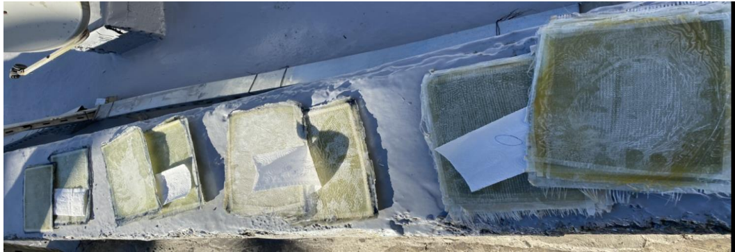
Şekil 3.6. Poliürea kaplama öncesinde zımparalanan CFTP kompozit numuneleri
