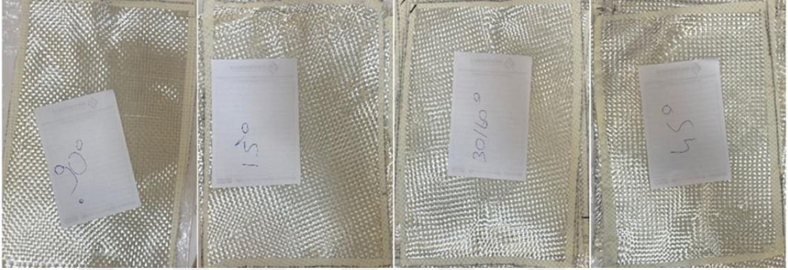
Şekil 3.2. Farklı açılarda kesilmiş dokuma cam fiberler
