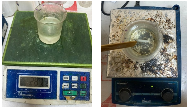
Şekil 3.3. Epoksi reçine ve sertleştiricinin tartılma ve karıştırılma aşaması
