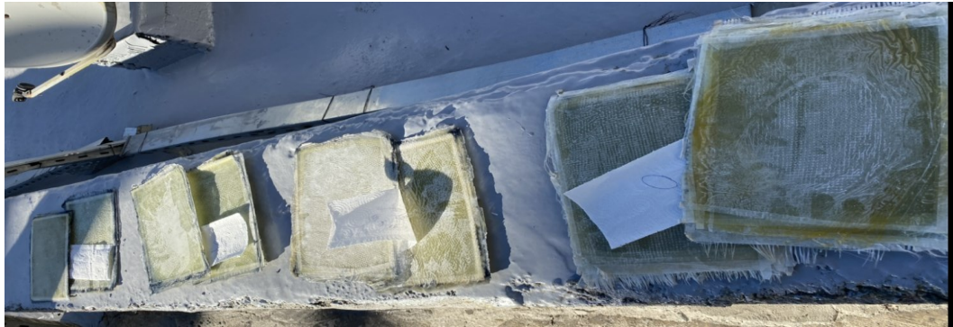
Şekil 3.6. Poliürea kaplama öncesinde zımparalanan CFTP kompozit numuneleri
