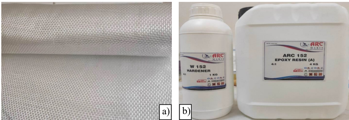
Şekil 3.1. Kompozit üretiminde kullanılan a) dokuma cam fiber(takviye) ve b) epoksi set (matris) malzemeleri
