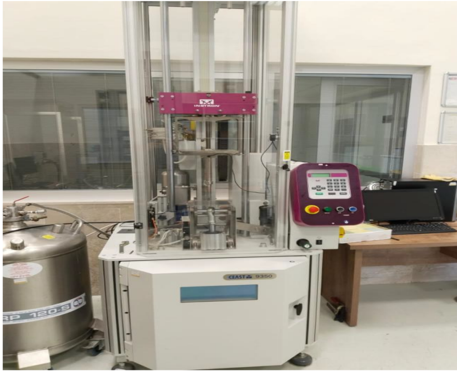
Şekil 3.8. Ağırlık düşürme deney düzeneği
