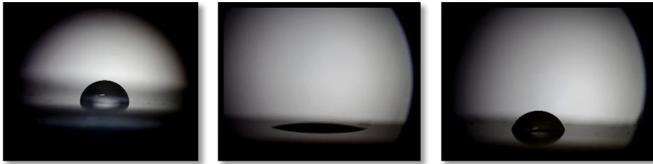
Şekil 2.4 Yüzeye bırakılan damla görüntüsü (Sırasıyla: Su, Parafin, Gliserol)
