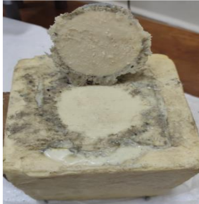
Şekil 4.21. Termoset beton kaplama yüzeyine termoset beton kaplama uygulamasında numunede kopma şekli
