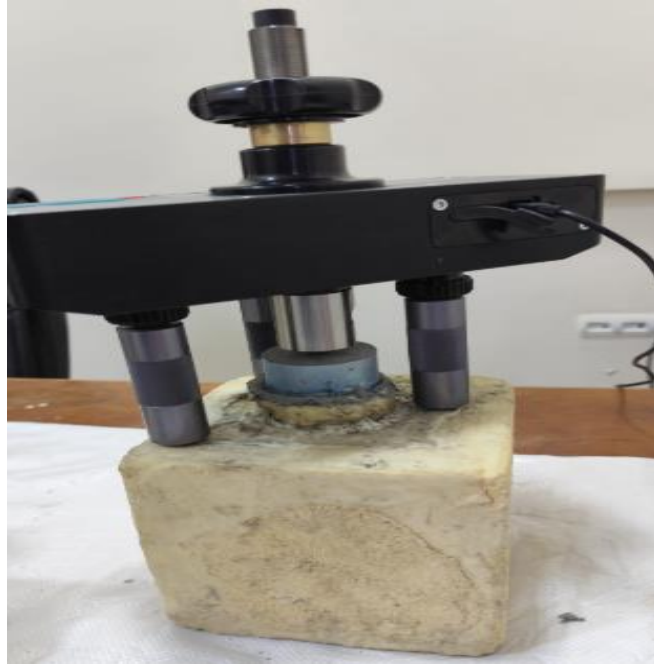
Şekil 4.19. Yapışma deneyi çekme diskinin cihaza montesi ve deneyin uygulanması
