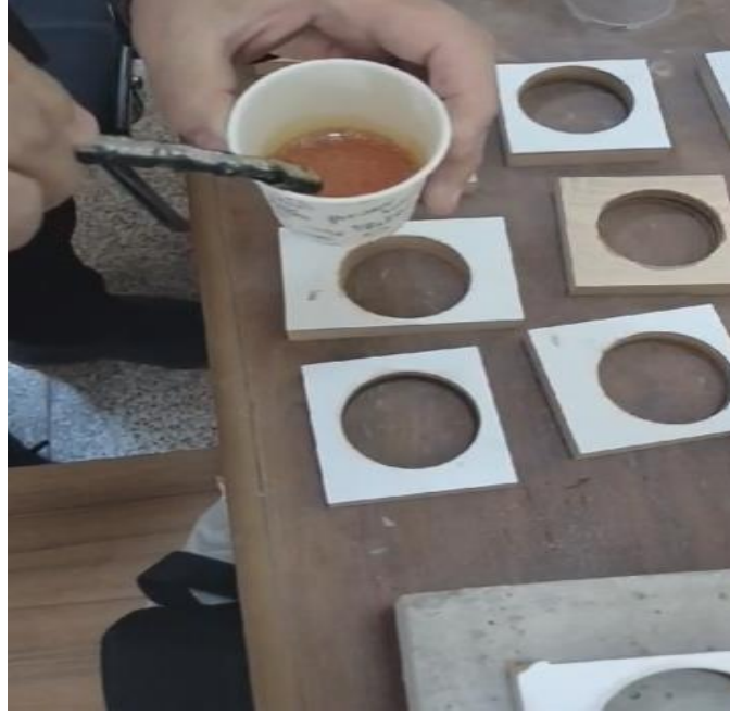
Őekil 3.18. Kalıp ierisine termoset beton dkm aaması
