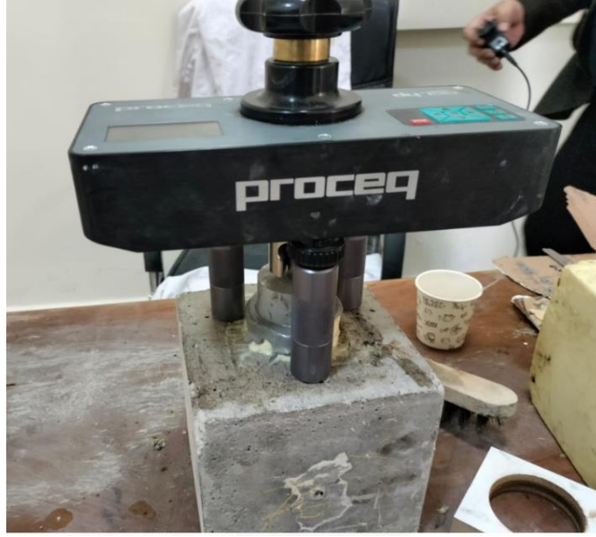
Şekil 0.16. Normal dayanımlı beton üzeri termoset beton yapışma deneyi uygulaması
