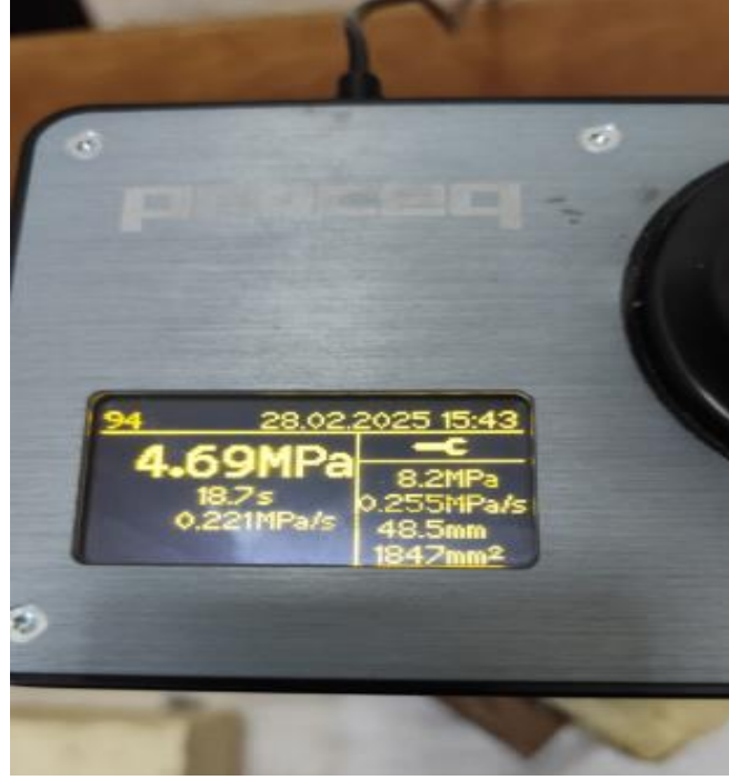
Şekil 4.20. Termoset üzeri termoset kaplamada otomatik kaydedilen yapışma dayanım değeri
