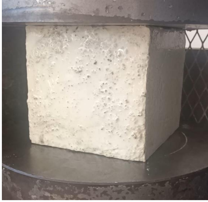
Şekil 0.9. İdeal termoset beton numunesinin basınç deneyine alınması
