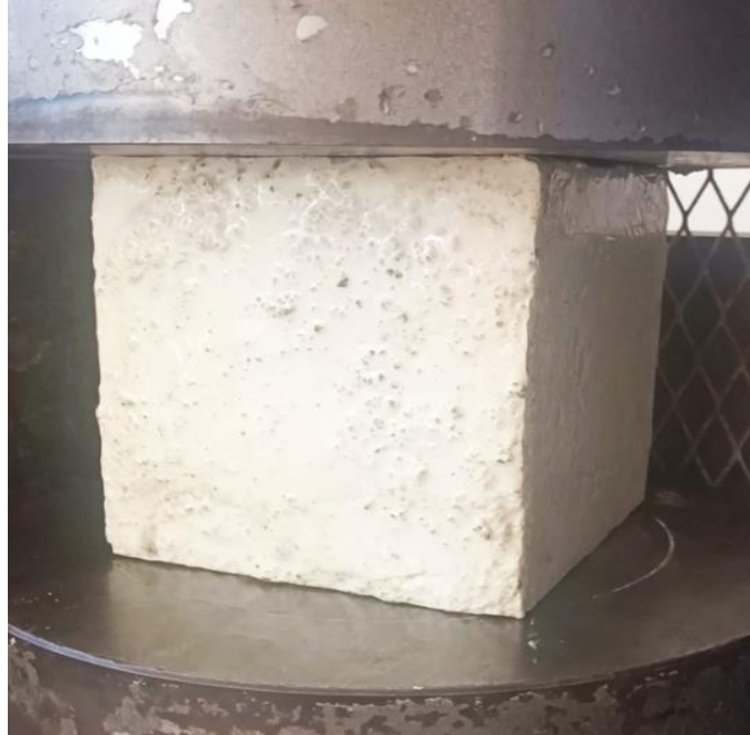
Şekil 4.4. İdeal numune basınç dayanım deney görüntüsü
