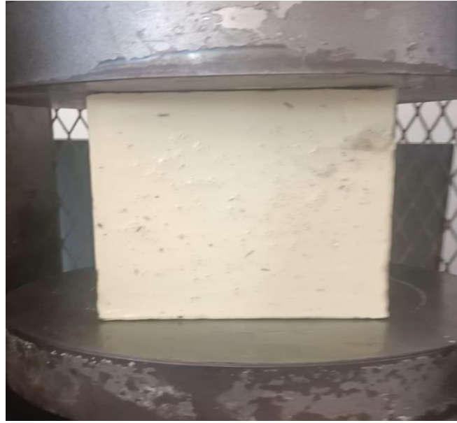
Şekil 0.8. Şahit termoset beton numunesinin basınç deneyine alınması
