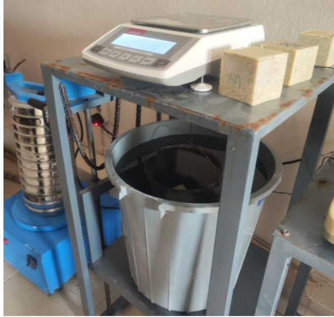
Şekil 0.10. Böhme aşınma deneyi öncesi numune görünümü
