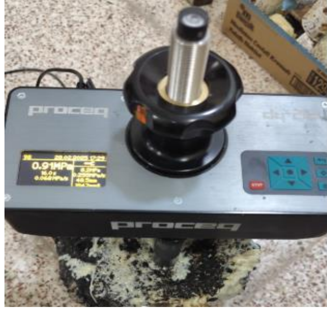
Şekil 4.22. Asfalt kaplama üzeri termoset kaplamada otomatik kaydedilen yapışma dayanım değeri
