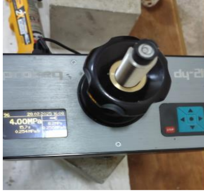
Şekil 4.17. Beton üzeri termoset kaplamada yapışma deney cihazı ve otomatik kaydedilen yapışma dayanım değeri
