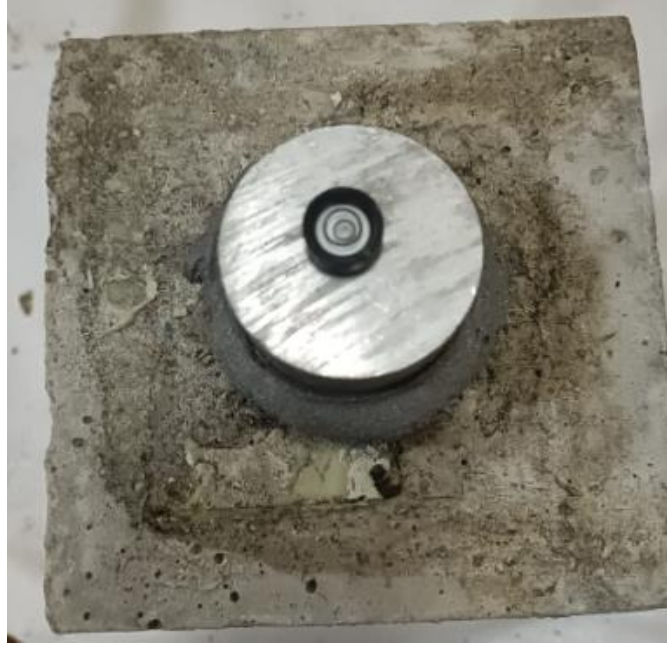
Şekil 3.22. Yapışma deneyi çekme diskinin kurumaya bırakılması
