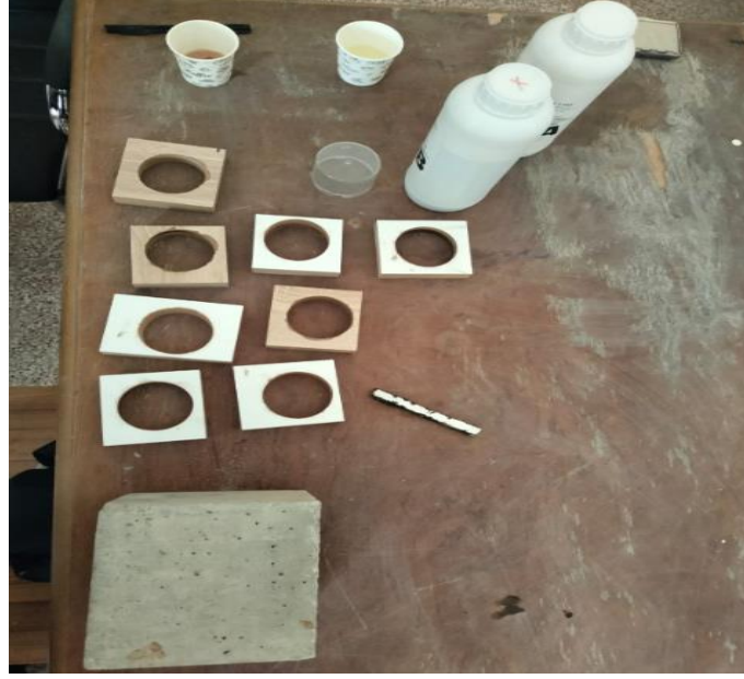
Şekil 3.16. Yapışma deneyi hazırlık aşaması
