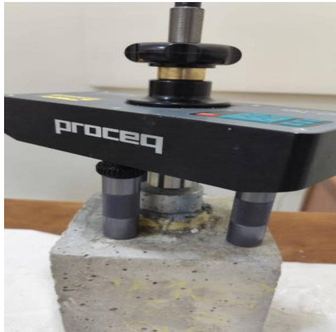
Şekil 4.16. Yapışma deneyi çekme diskinin cihaza tespit edilmesi
