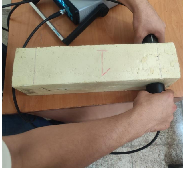
Şekil 4.7. UPV testinin yapılışı
