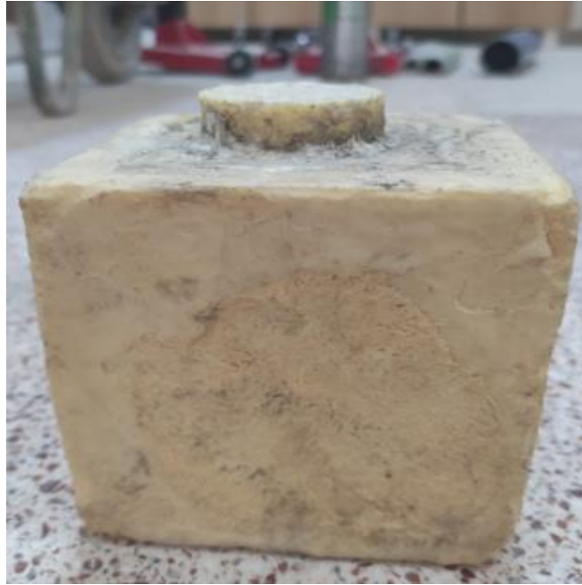
Şekil 3.25. Termoset betonun termoset beton yüzeyinde sertleşme aşaması sonrası görünümü
