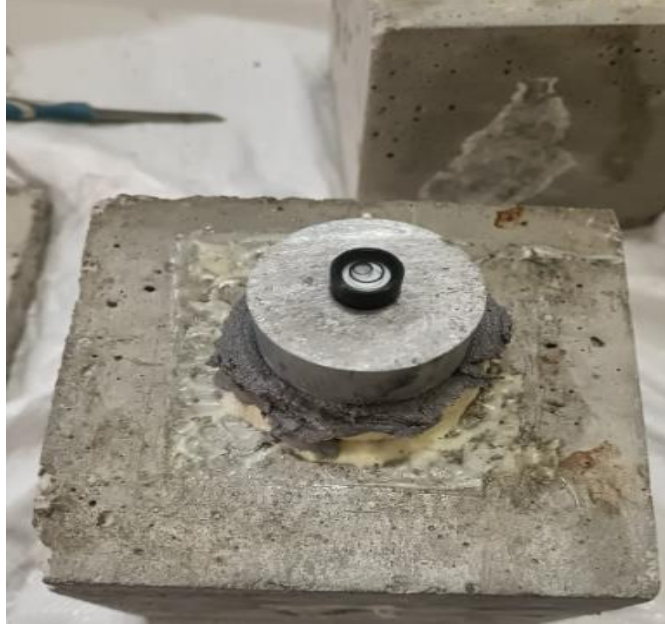
Şekil 0.13. Normal beton üzeri yapışma deneyi öncesi üst katmanın teraziye alınması
