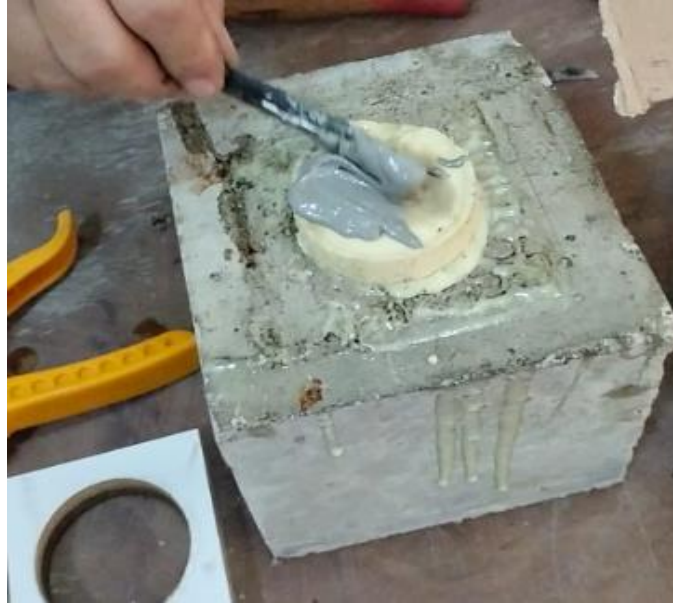
Şekil 3.21. Termoset betonun sertleştikten sonra, üzerine yapıştırıcı sürülmesi
