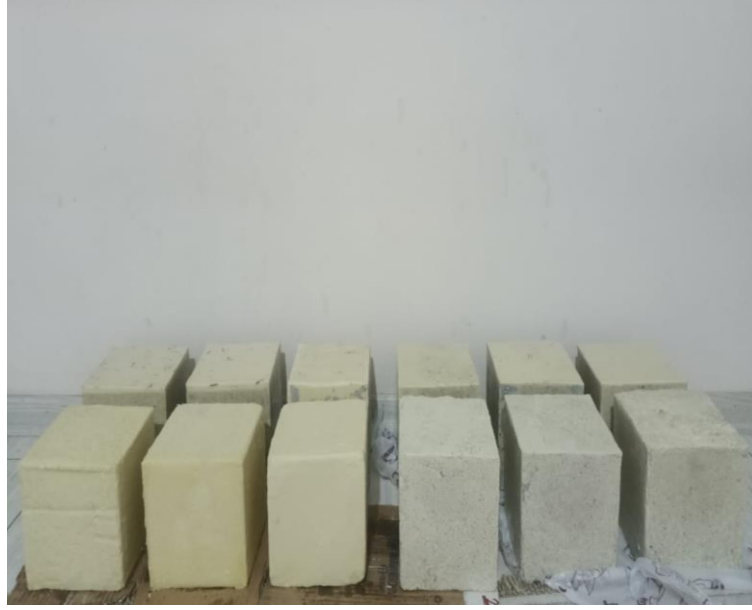
Şekil 4.1. Poliüretan reçine ve agregadan oluşan numuneler
