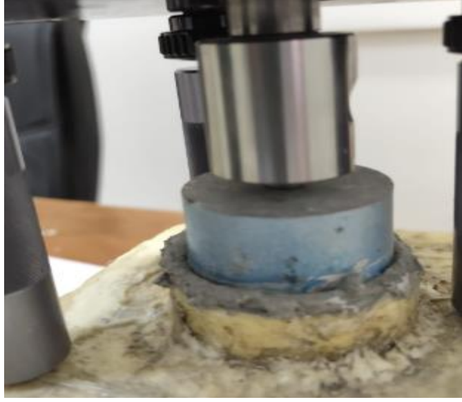
Şekil 0.15. Termoset beton üzeri termoset beton yapışma deneyi uygulaması
