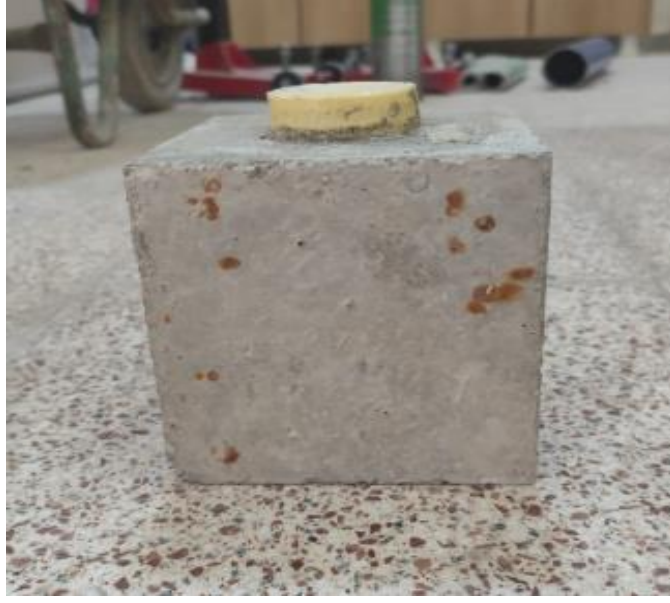
Şekil 3.20. Termoset betonun normal dayanımlı beton yüzeyinde sertleşme aşaması sonrası görünümü
