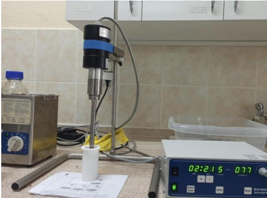
Resim 3. 3. Karışımın ultrasonik banyoda karıştırılması.
