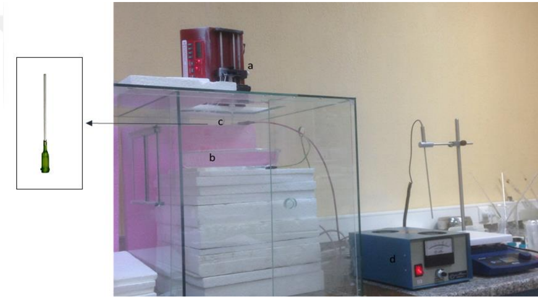
Şekil 16: Kendi tasarlanmış olduğumuz ıslak elektro eğirme düzeneği a) şırınga pompası b) koagülasyon banyosu c) küt uçlu şırınga ucu d) voltaj kaynağı
