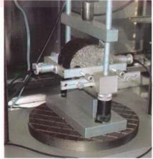
Şekil 4.7. İndirekt Çekme Aletine Numunelerin Yerleştirilmesi
