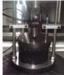
Şekil 4.9. Numunenin SYSS Deney Aletine Yerleştirilmesi
