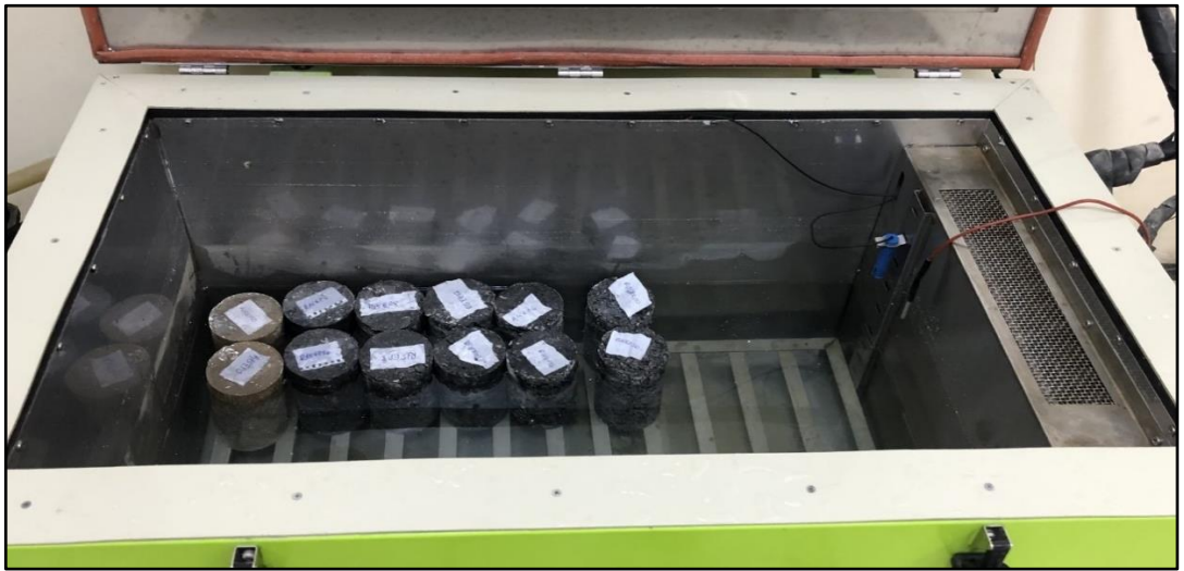
Şekil 4.5. Donma-çözünme testinin uygulama görseli
