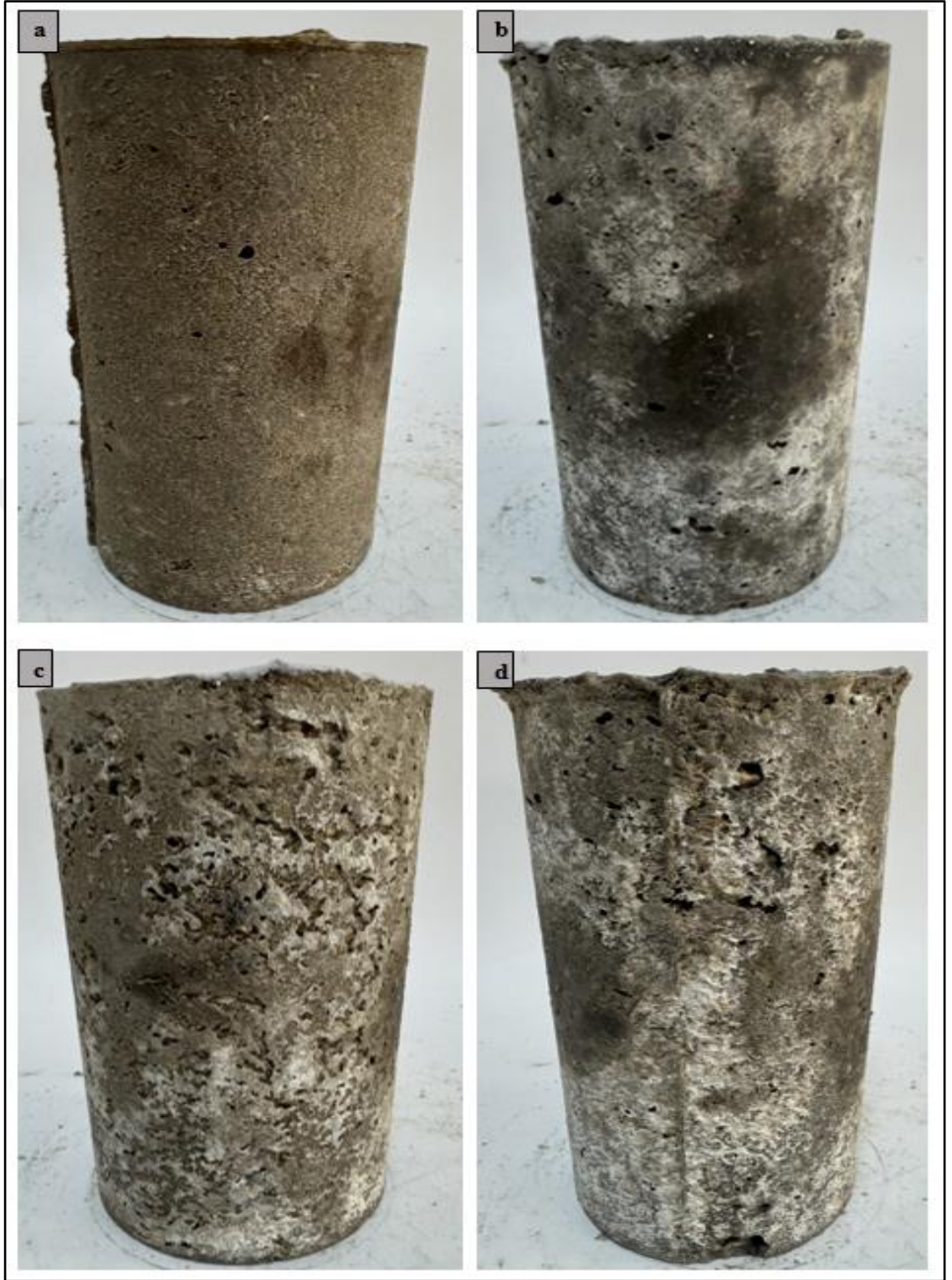
Şekil 5.5. Vinilester reçineli polimer betonların 300 donma-çözünme döngüsü sonrasındaki görüntüleri, a: Kontrol betonu (VRE0), b: %8 e-atıklı polimer beton (VRE8), c: %16 e-atıklı polimer beton (VRE16), d: %20 e-atıklı polimer beton (VRE20).
