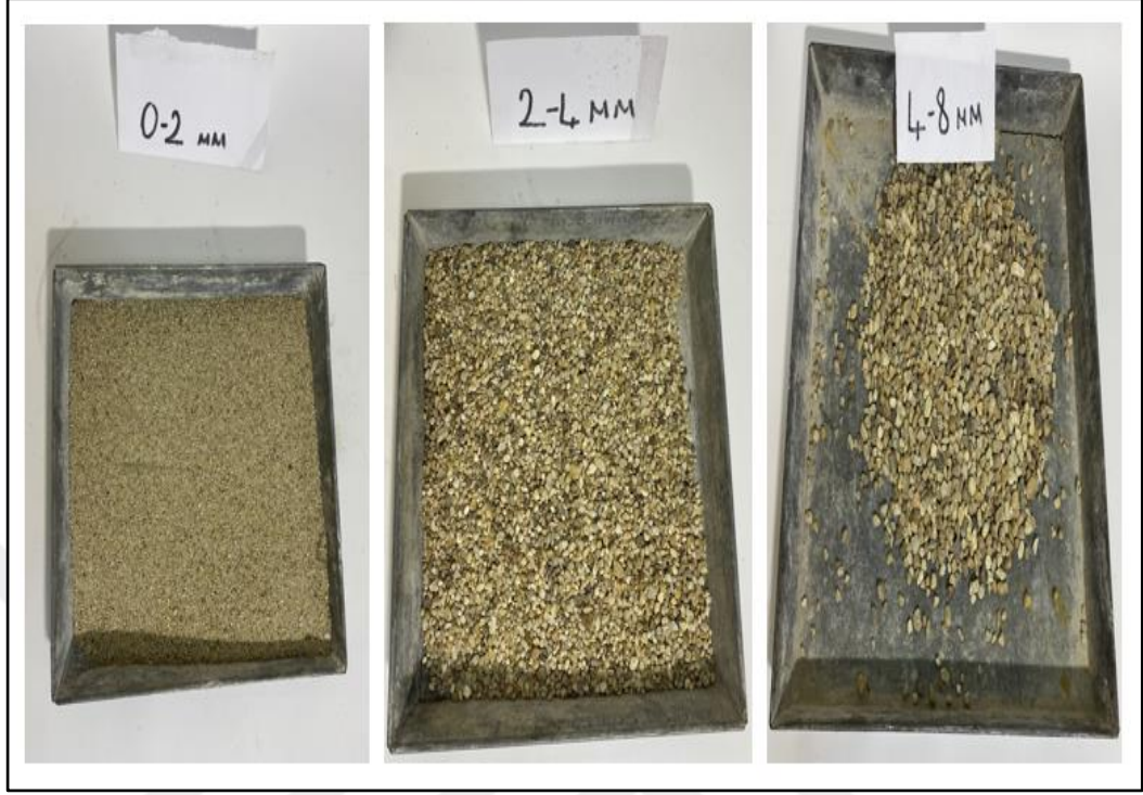
Şekil 4.2. Kuvars agregalarının elek analizi sonrası görüntüleri
