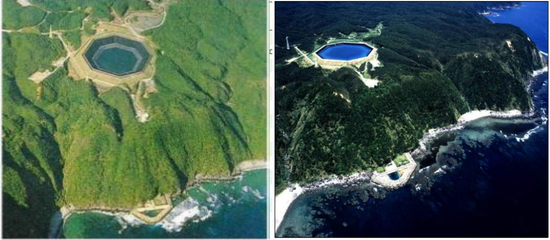
Şekil 2.9. Japonya’da Denizi Alt Rezervuar Olarak Kullanan Okinawa PDHES
