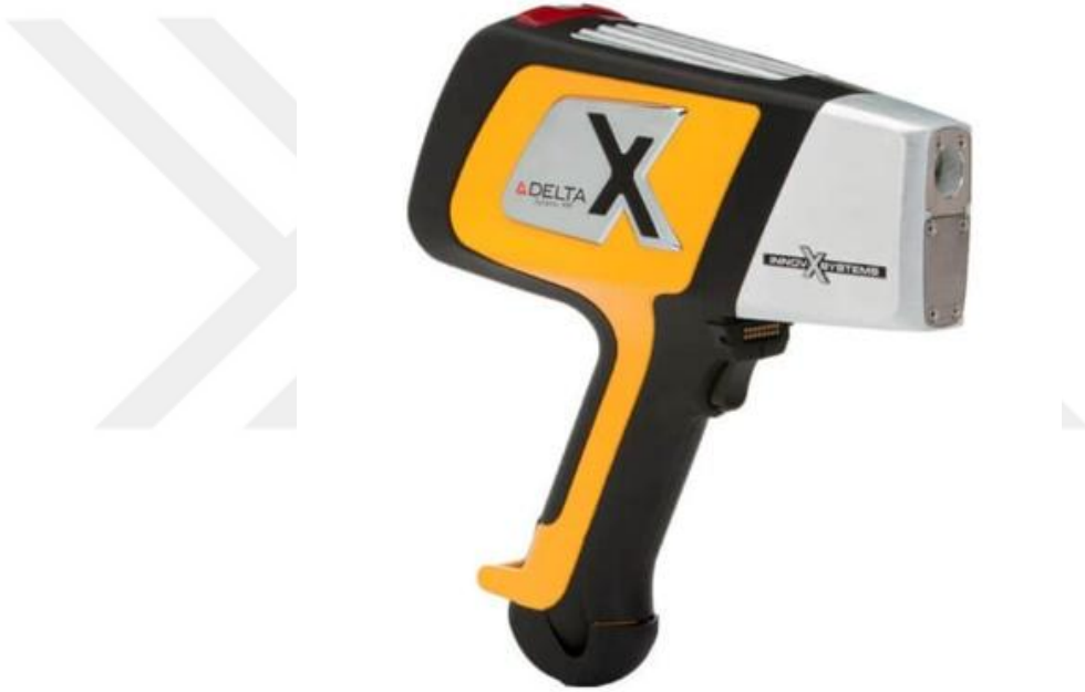
Şekil 16. Olympus Delta P-XRF
