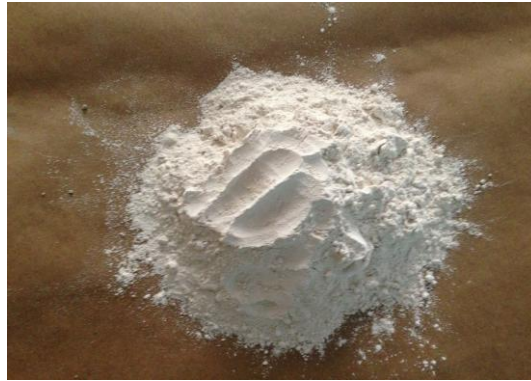
Şekil 6.1. 0.25 mm'lik elekten geçirilmiş atık mermer tozu
