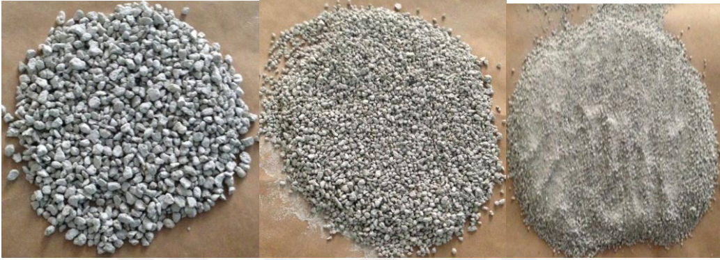
Şekil 2.5. 0-2, 2-4, 4-8 mm olarak boyutlandırılmış pomza agregaları
