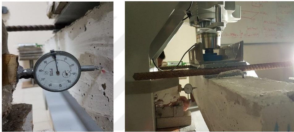
Şekil 3.52. Lento eğilme direnci deneyinde orta nokta yanal yer değiştirme ölçümü
