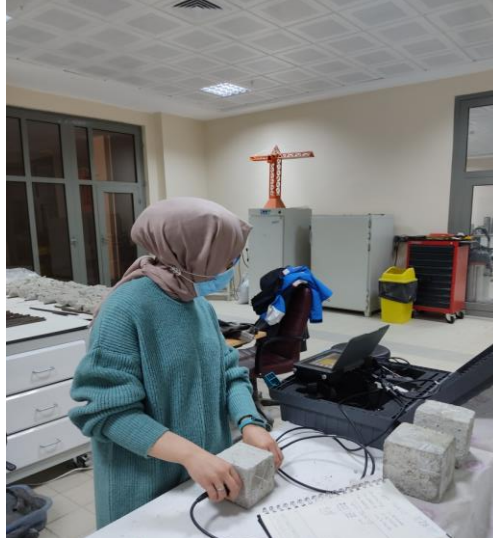
Şekil 3.40. Lentolara ait küp numunelere ultra ses geçiş hızı deneyi yapılması
