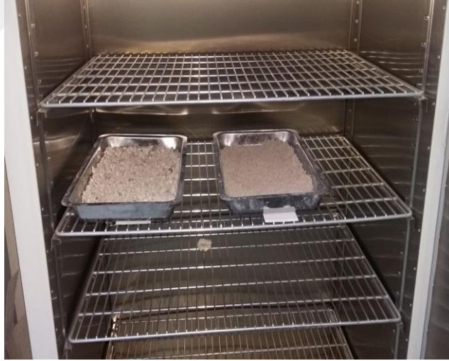
Şekil 3.16. Mevcut nem tespiti için etüve atılan agregaların görüntüsü
