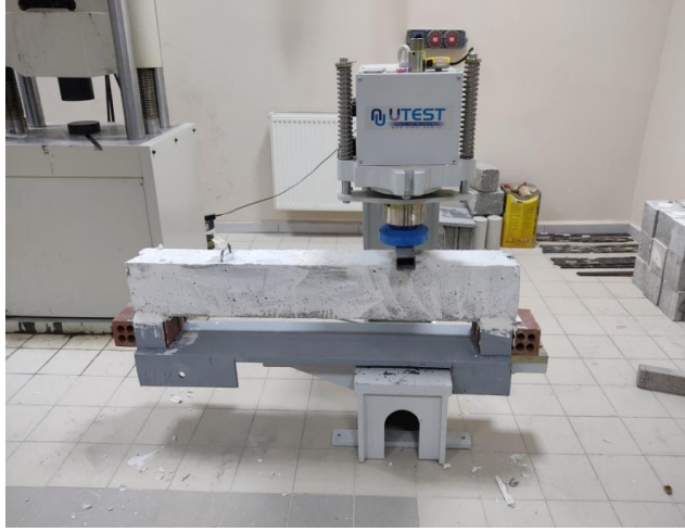
Şekil 3.47. Lento kayma direnci tayini deneyi
