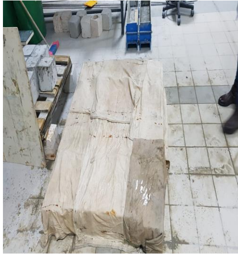
Şekil 3.39. Kalıptan çıkarılan lentolara nemli kür uygulanması
