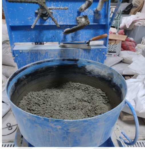
Şekil 3.23. Laboratuvar tipi betoniyerde hafif beton hazırlanması
