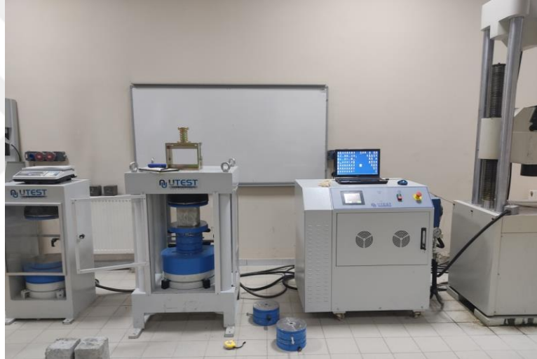
Şekil 3.41. Lento imalatında kullanılan hafif beton numunelere eksenel basınç dayanımı testi uygulanması.
