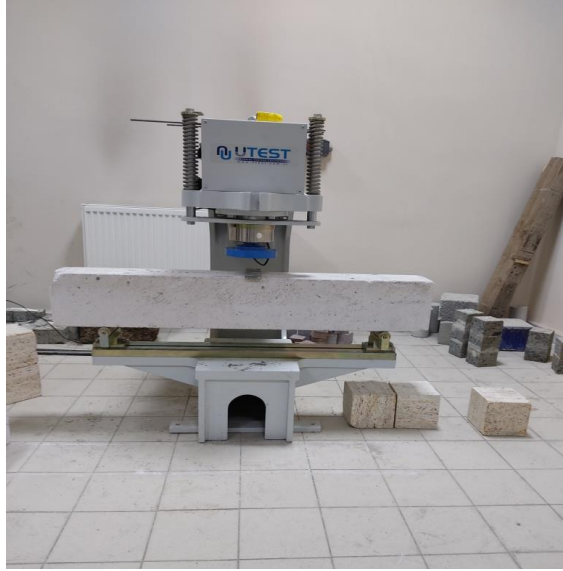
Şekil 3.27. Donatı bağlantı tayini amacıyla yapılan lento eğilme deneyine ait genel bir görüntü.
