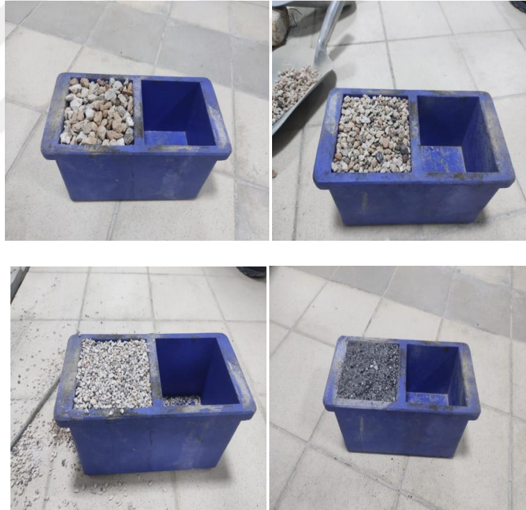
Şekil 3.10. Pomza ve obsidyen türü agregaların birim ağırlığının tayini
