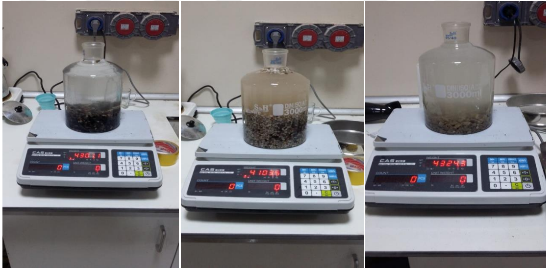
Şekil 3.14. (a), (b) ve (c) Agregaların su içerisindeki ağırlıklarının tespiti
