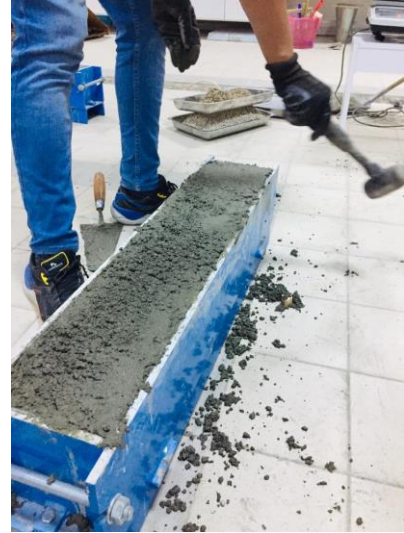
Şekil 3.24. Beton karışımının lento kalıplarına yerleştirilmesi
