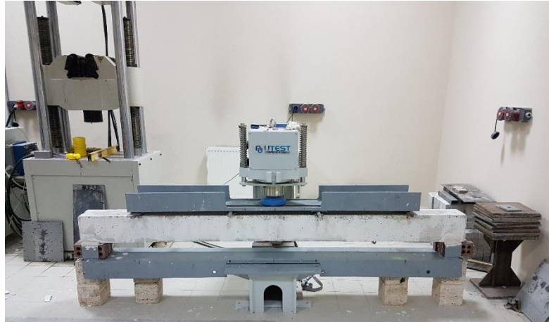
Şekil 3.51. Dört noktalı lento eğilme deneyi için yükleme kirişi değişimi
