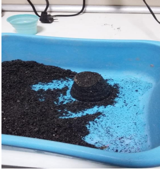
Şekil 3.13. İnce agregaların doymun kuru yüzey haline getirilmesi işlemi
