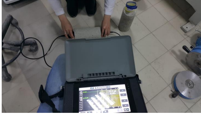
Şekil 3.19. Ultra ses geçiş hızı deney uygulama görüntüsü
