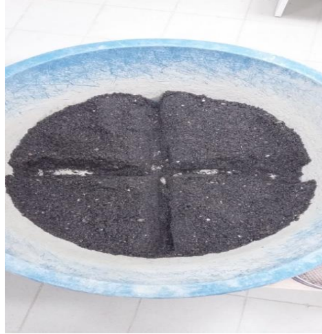
Şekil 3.3. Çeyrekleme yöntemiyle numune küçültme
