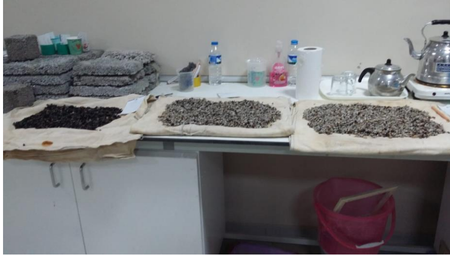
Şekil 3.12. İri agregaların doymun kuru yüzey haline getirilmesi işlemi
