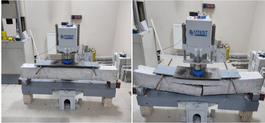
Şekil 4.5. Eğilme momenti taşıma kapasitesi deneyine tabi tutulan 1,8 m açıklıklı lentonun deney öncesi ve sonrası görüntüleri.
