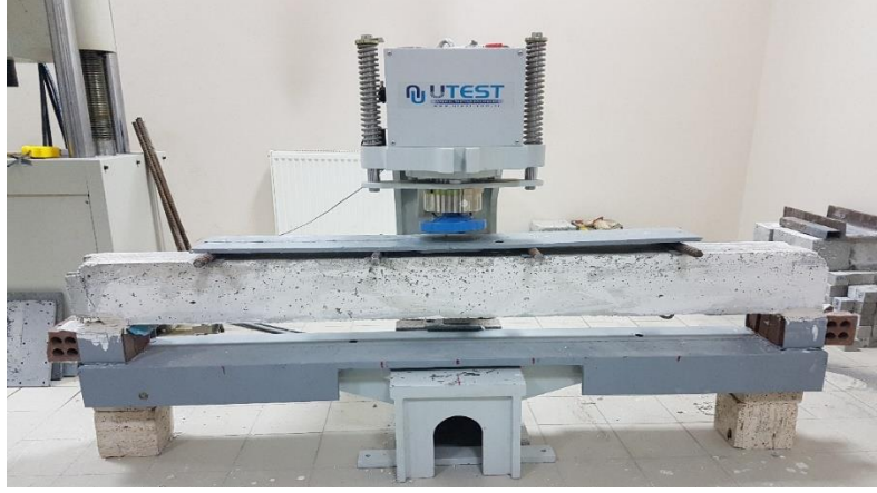
Şekil 3.50. Dört noktalı lento eğilme deneyi
