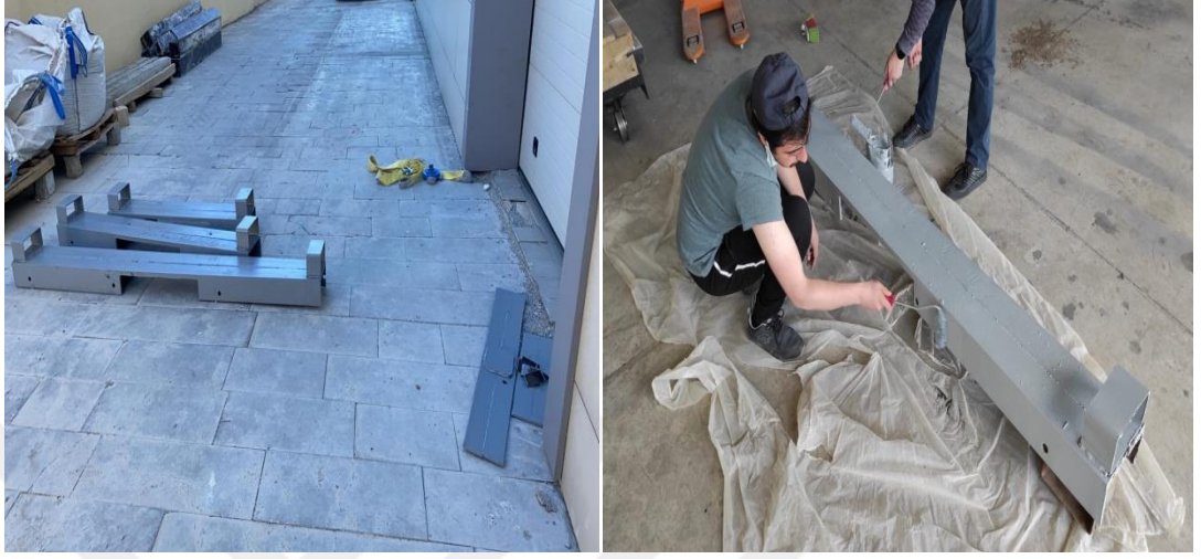
Şekil 3.42. Yükleme düzeneği için ilave çelik mesnet kirişi hazırlıkları
