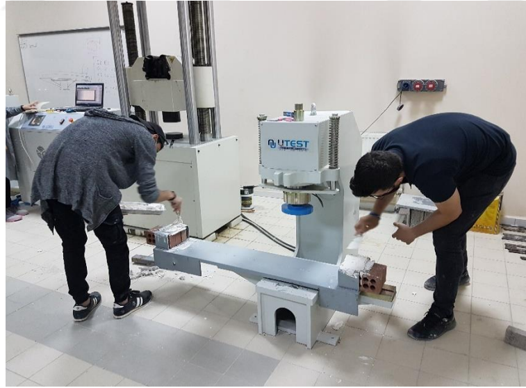
Şekil 3.45. Yükleme düzeneğinde mesnet parçaları üzerine alçı uygulaması
