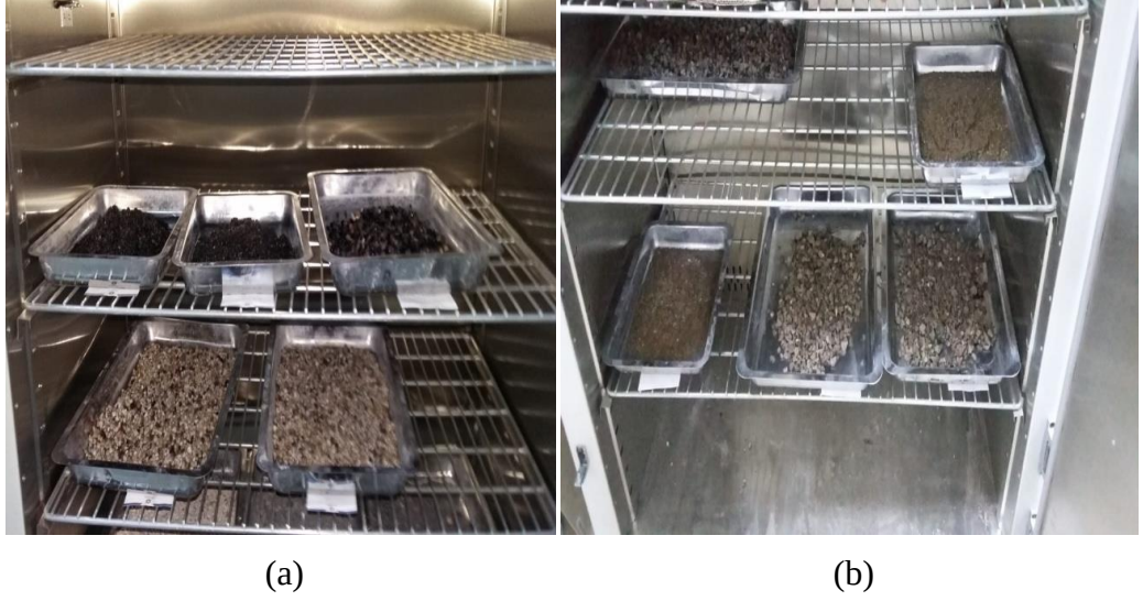
Şekil 3.15. (a) ve (b) Tamamen kuru hale gelmesi için etüve bırakılan agregaların görüntüsü.
