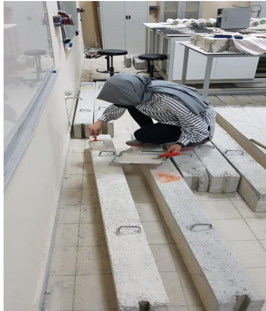
Şekil 3.43. Lentolara kireç badanası yapılması
