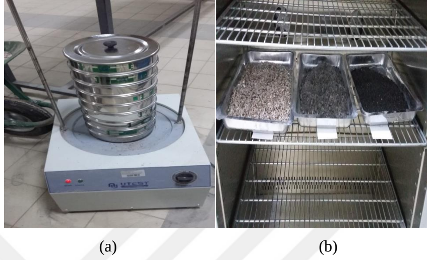
Şekil 3.4. (a) Elek takımı sarsma cihazı, (b) Elek analizinde kullanılan etüv
