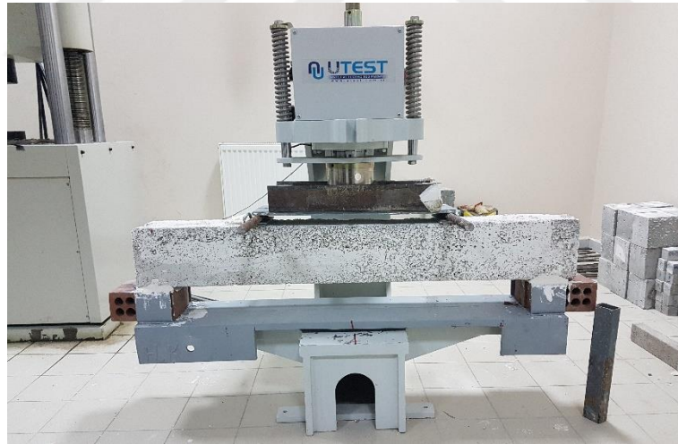
Şekil 3.49. İki noktalı lento eğilme deneyi
