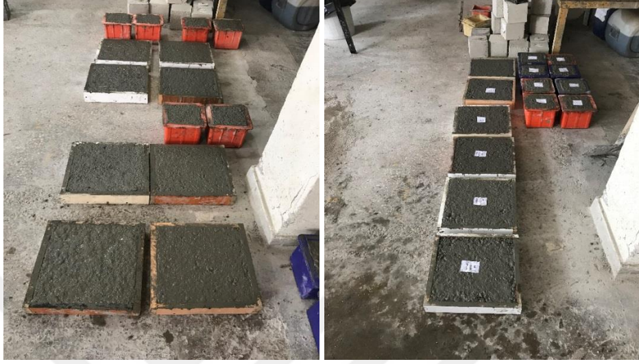
Şekil 3.12. Isı iletkenlik katsayısı ve basınç dayanımı için hazırlanan numuneler
