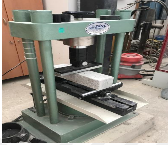
Şekil 3.16. Eğilme deneyi düzeneği
