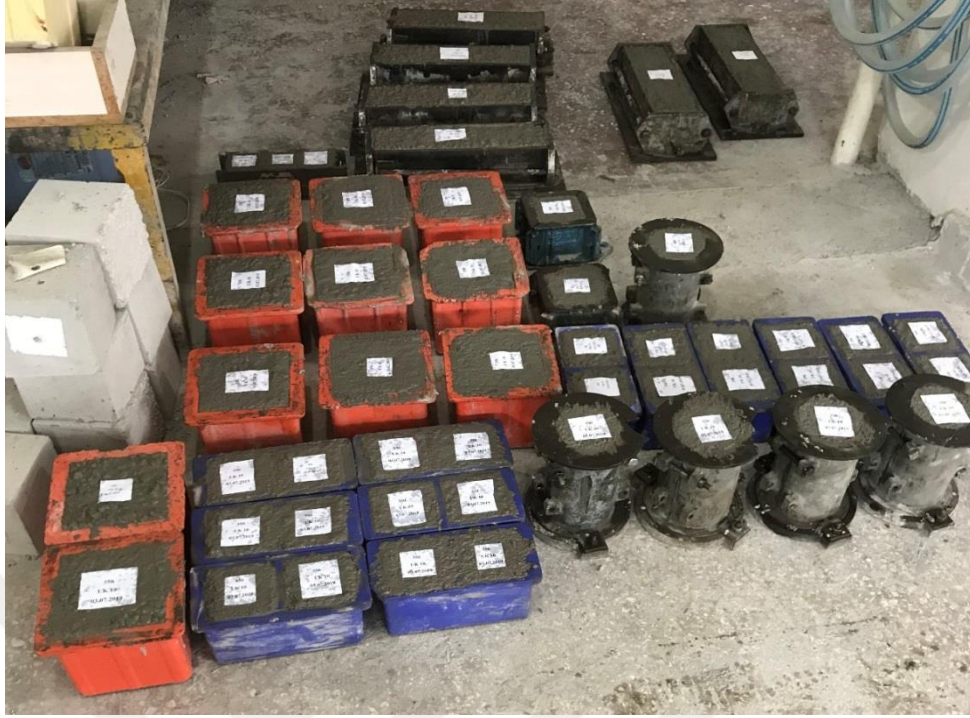
Şekil 3.10. Üretim sonrası kalıplarında numuneler
