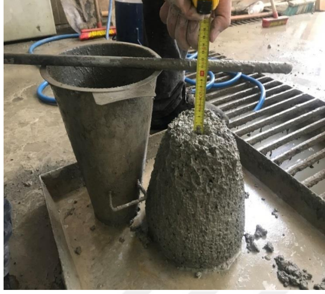
Şekil 3.13. Çökme konisi ve çökme deneyi
