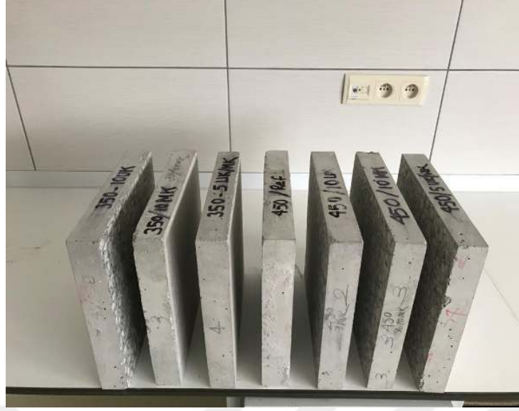
Şekil 3.27. Isı iletkenlik katsayısı ölçümünde kullanılan numuneler
