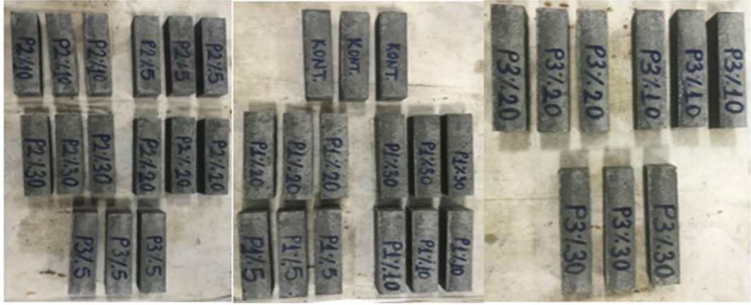
Şekil 3.10 24 saat sonra kalıptan çıkarılan harç numuneleri
