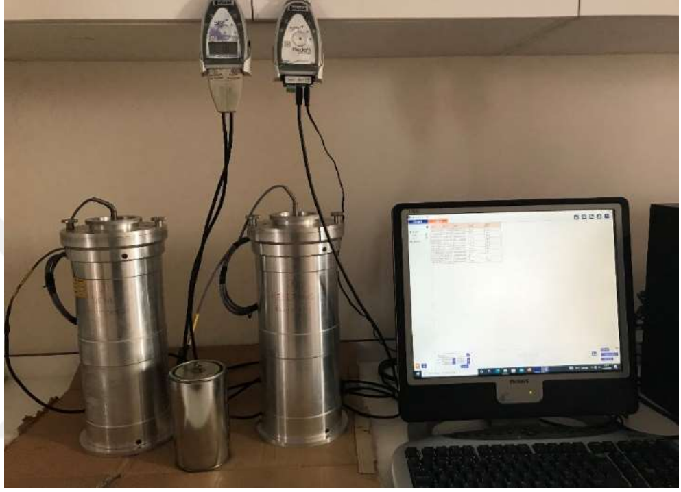
Şekil 3.15 Hidratasyon ısısı kalorimetre deney düzeneği
