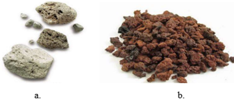
Şekil 1.3 MTA raporunda, a. asidik ve b. bazik pomza taşlarının görünümü
