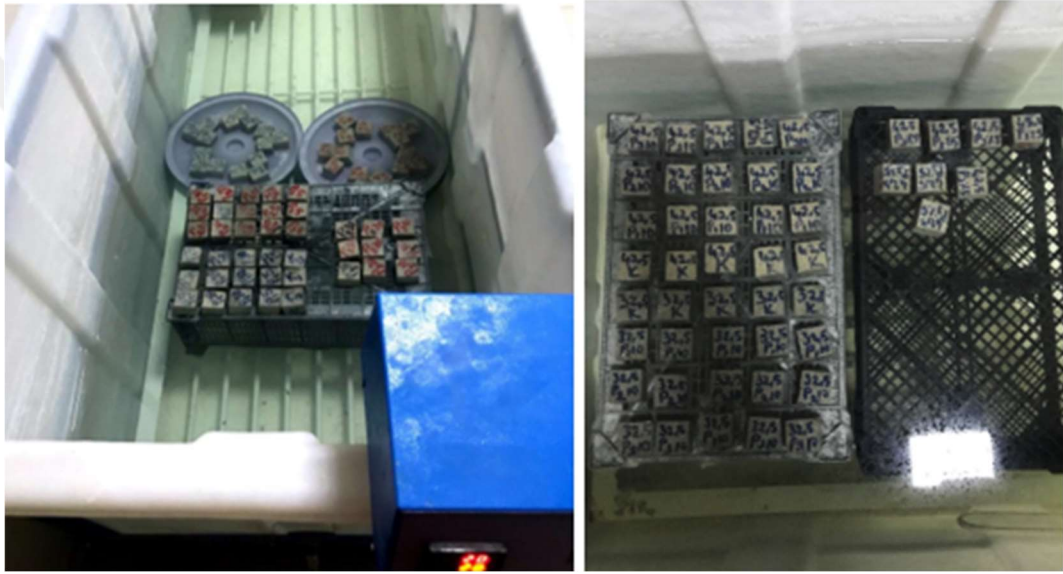
Şekil 3.12 Harç numunelerinin su kürü işlemi
