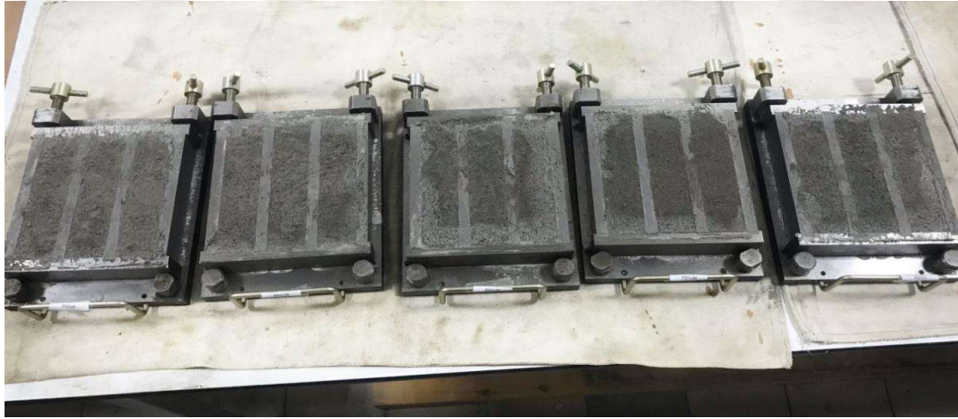
Şekil 3.9 24 saat kalıpta bekletilen harç numuneleri
