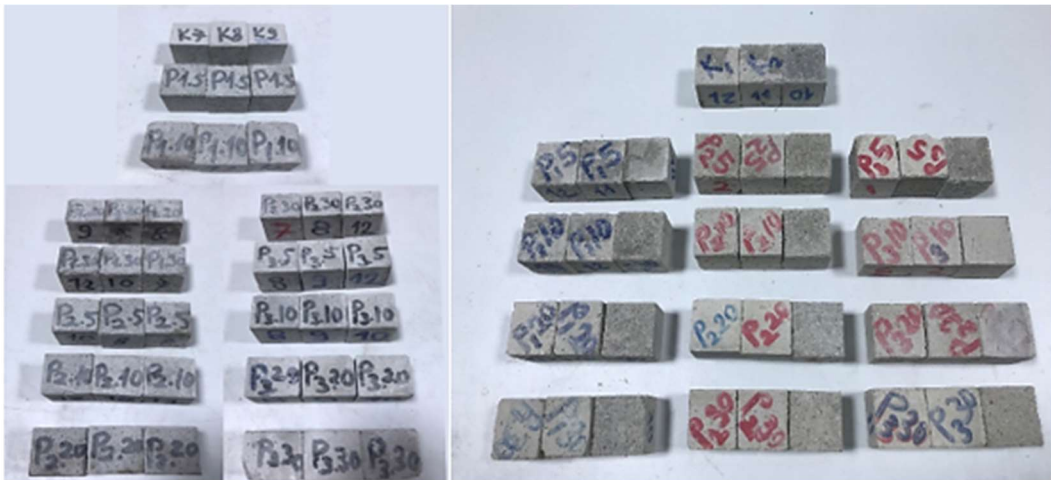
Şekil 3.13 40x40x40 mm küp harç numuneleri
