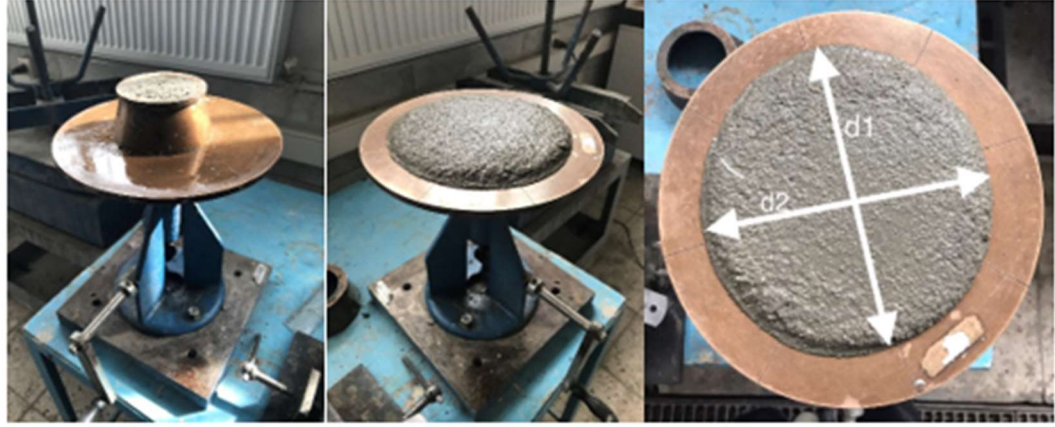
Şekil 3.7 Harç yayılma tablası, a. Harcın kesik koniye yerleştirilmesi, b. 15 vuruş sonrası yayılan harç, c. Yayılan harcın d_1 ve d_2 doğrularında ölçülmesi.
