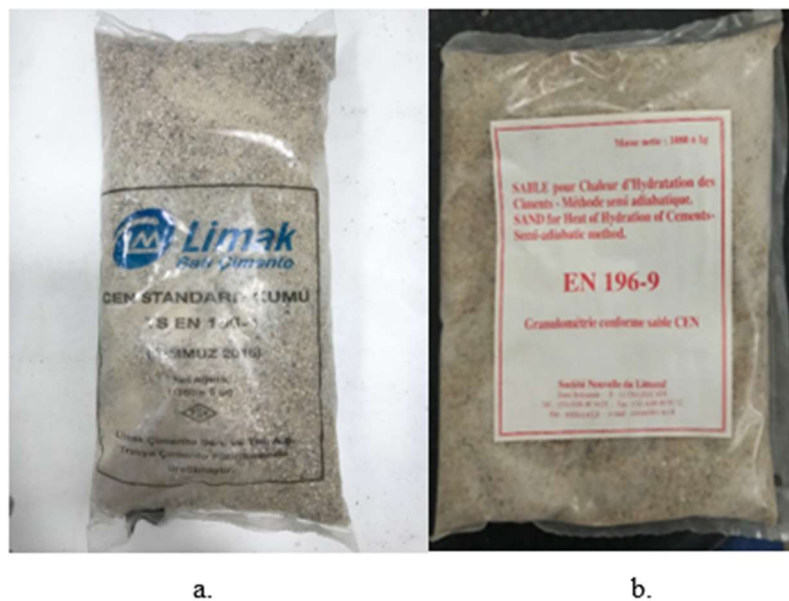
Şekil 3.2 CEN standart kumu ( a. TS EN 196-1 standardında belirtilen 1.350 g , b. TS EN 196-9 standardında belirtilen 1.080 g).
