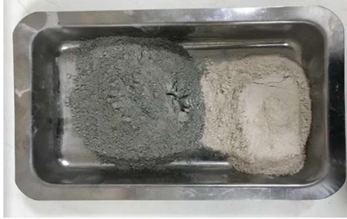
Şekil 3.1 Çimento ve pomza tozu
