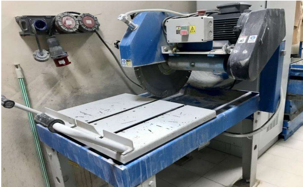
Şekil 3.11 Spiralli taş kesme cihazı
