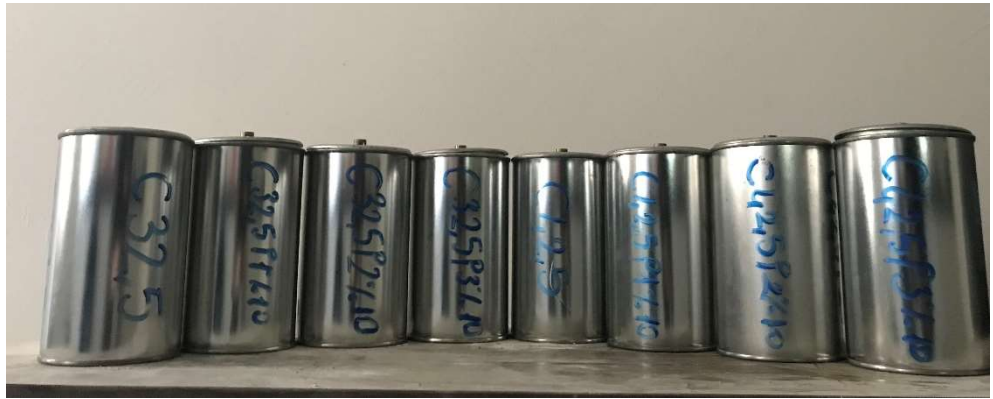
Şekil 3.16 Hidratasyon ısısı deneyi silindir harç numuneleri
