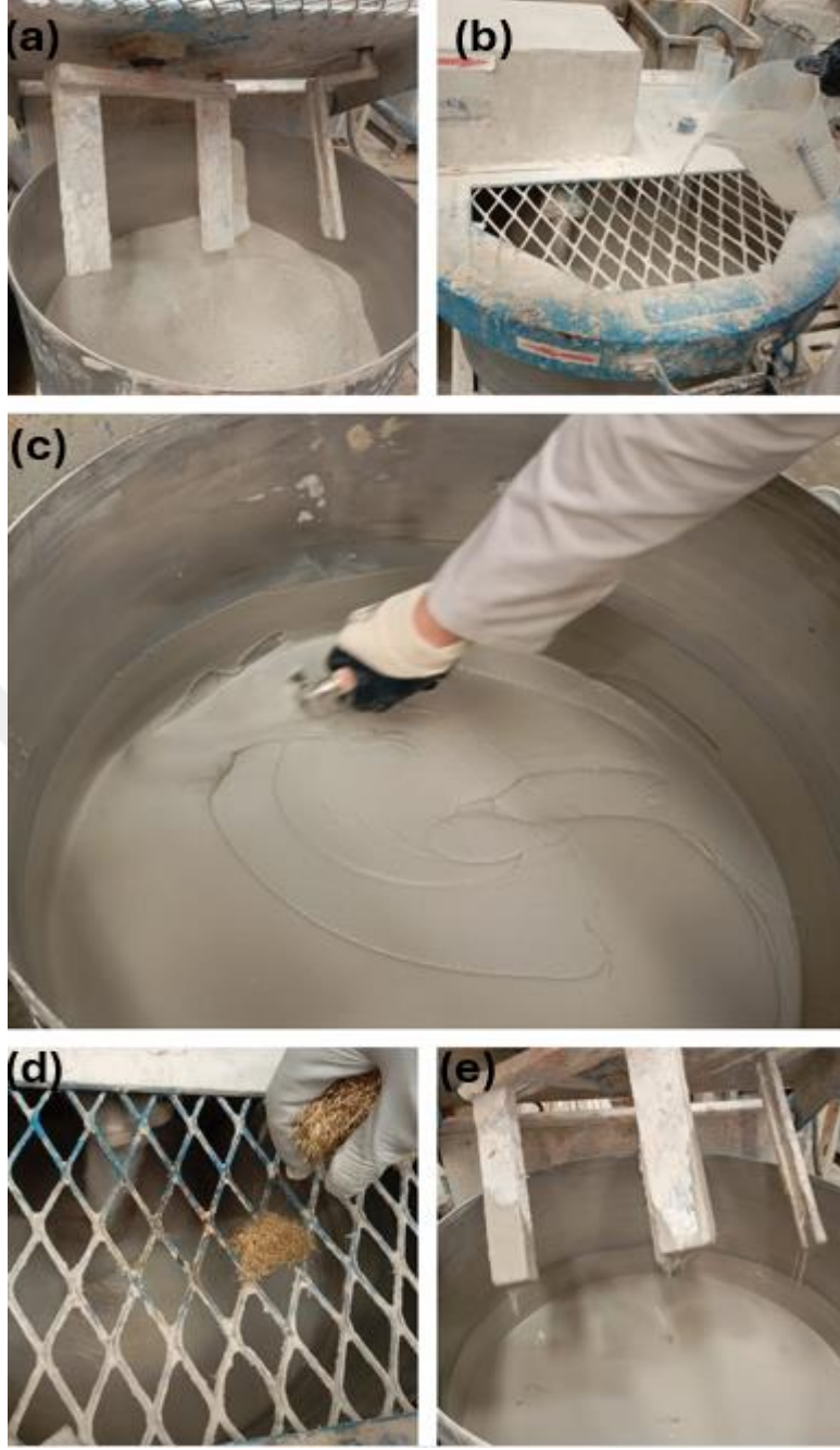
Şekil 2.13. UYPB harçlarının hazırlanması.
