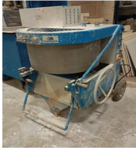
Şekil 2.12. UYPB numunelerinin hazırlandığı mikser.
