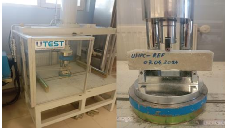
Şekil 2.23. Eğilme dayanım deneyi.
