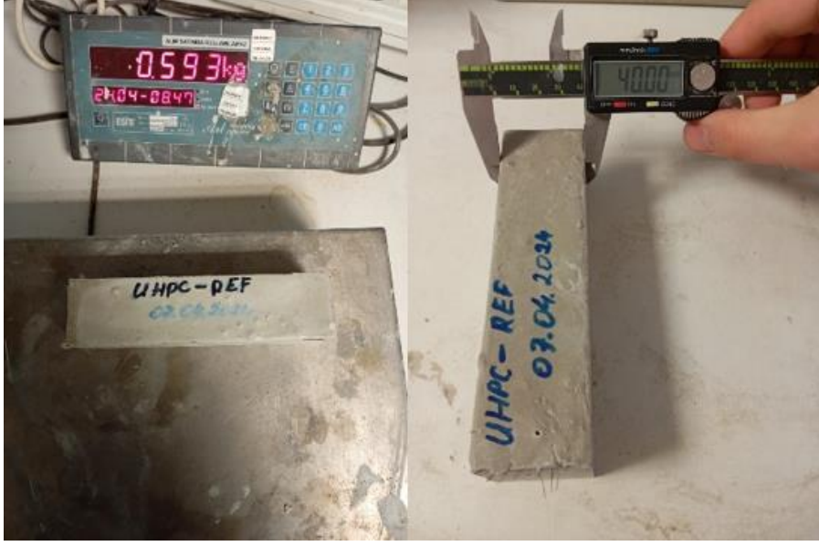
Şekil 2.21. UYPB numunelerinin ağırlık ve boyut ölçümleri.
