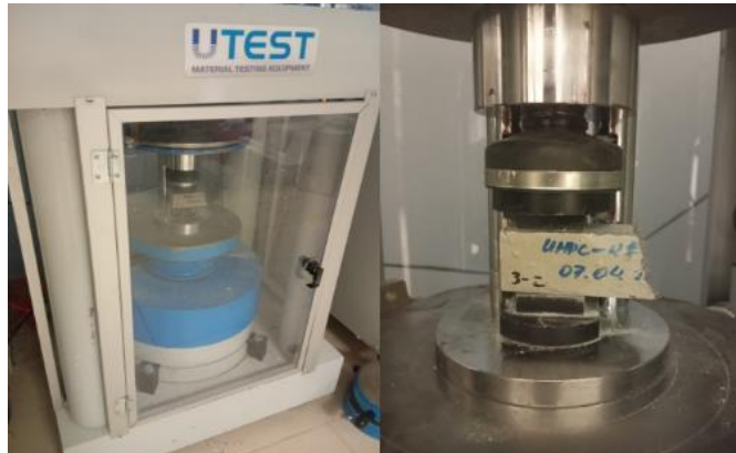
Şekil 2.24. Basınç dayanım deneyi
