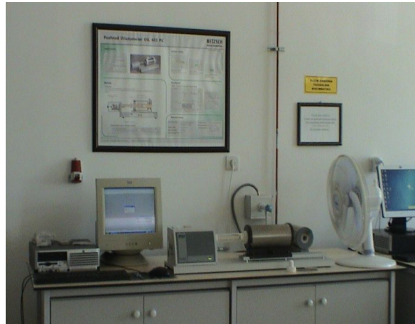
Şekil 7.13. Kullanılan Netzsch marka dilatometre cihazı.
