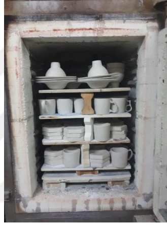
Görsel 4. 4. Hazırlanan sır deneme plakaları fırına doldurulmuştur
