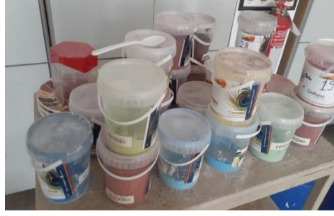
Görsel 4. 3. Dekor uygulaması için toz pigment hammaddelerin hazırlanması
