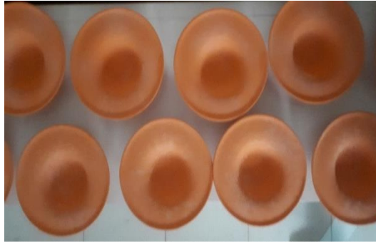
Görsel 4. 5. 23x23x5 cm 1000°C Saydam sır ile sırlanmış tabaklar
