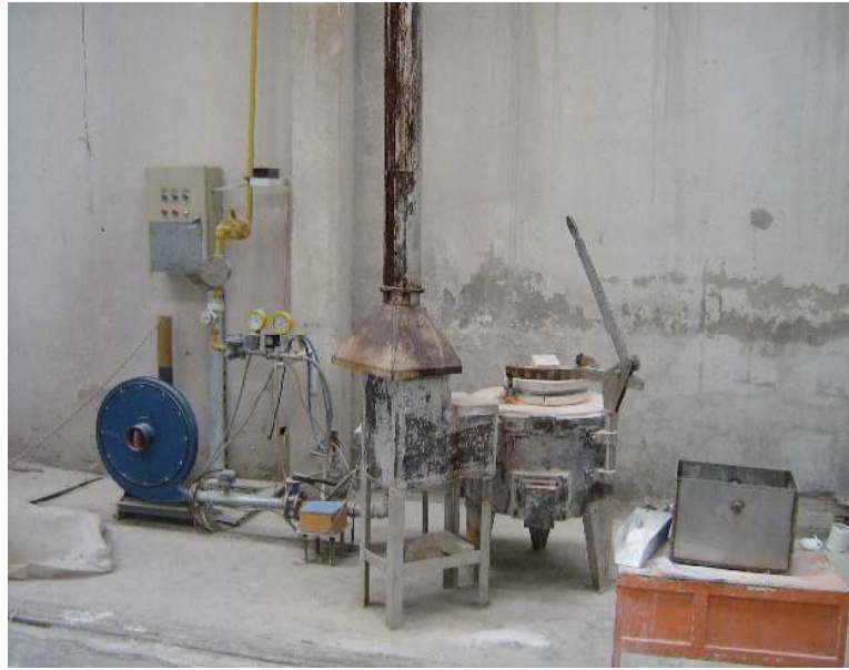
Şekil 2.1 Ergitme işlemlerinin yapıldığı doğalgazla çalışan frit fırını
