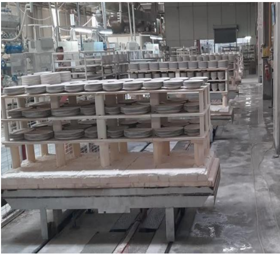
Şekil 16. Bonna Porselen A.Ş. endüstriyel tünel tipi bisküvi ve sırlı fırın (Forno Ceramica)
