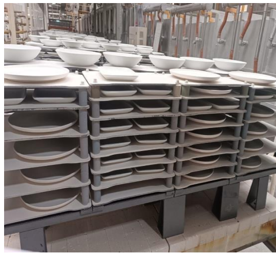
Şekil 16. Bonna Porselen A.Ş. endüstriyel tünel tipi bisküvi ve sırlı fırın (Forno Ceramica)
