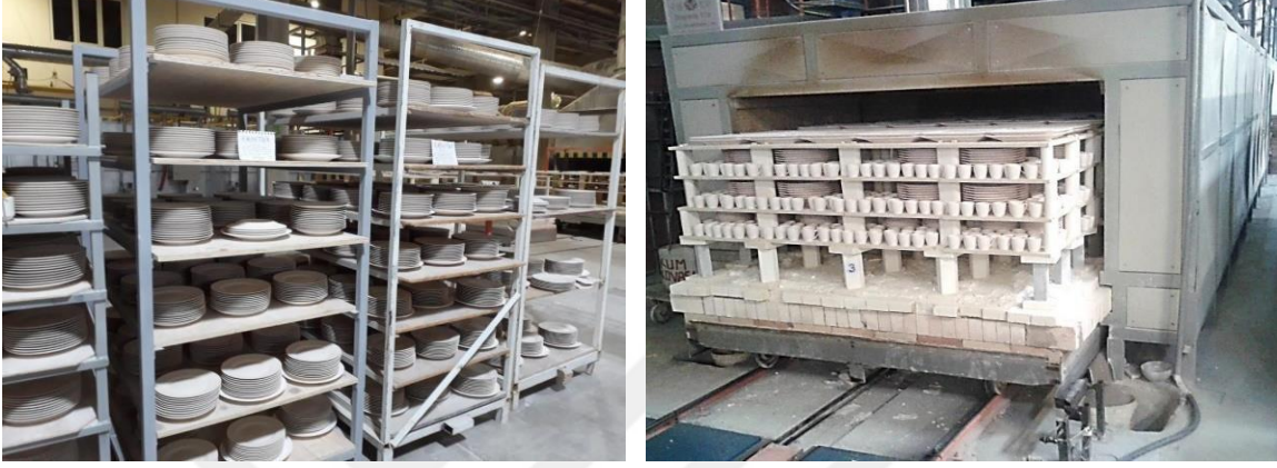
Şekil 12. Sırsız gövde pişiriminin endüstriyel ölçekte gösterimi (Tünel Fırın,Bonna Porselen A.Ş)
