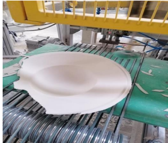
Şekil 10. Rötuş hattına giren ve zımparalanan ürün görseli (Dorst Technologies. "Isostatic Powder Presses", 17 Şubat 2024)
