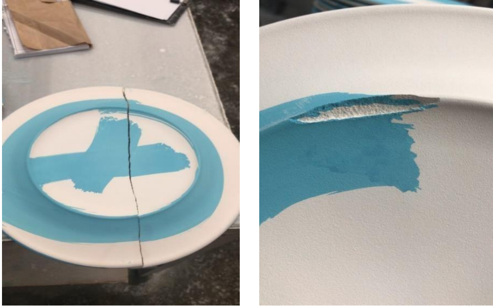
Şekil 31. Triyaj kontrolü esnasında karşılaşılan çatlak örnekleri
