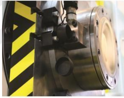
Şekil 6.b. İzostatik Toz Kalıp Sistemi Gösterimi
