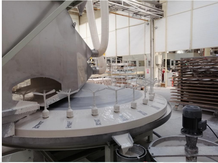
Şekil 13. Püskürtmeli sırlama işlemi (Bonna Porselen AŞ)
