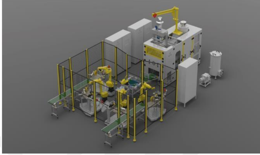
Şekil 6.b. İzostatik Toz Kalıp Sistemi Gösterimi
